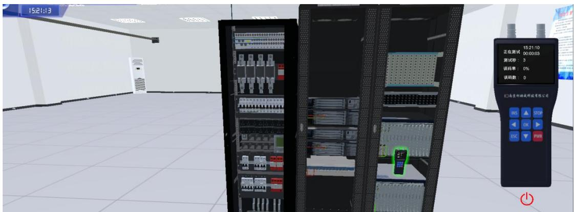
图 2.5.5.6 误码仪测量中继线接口设备
