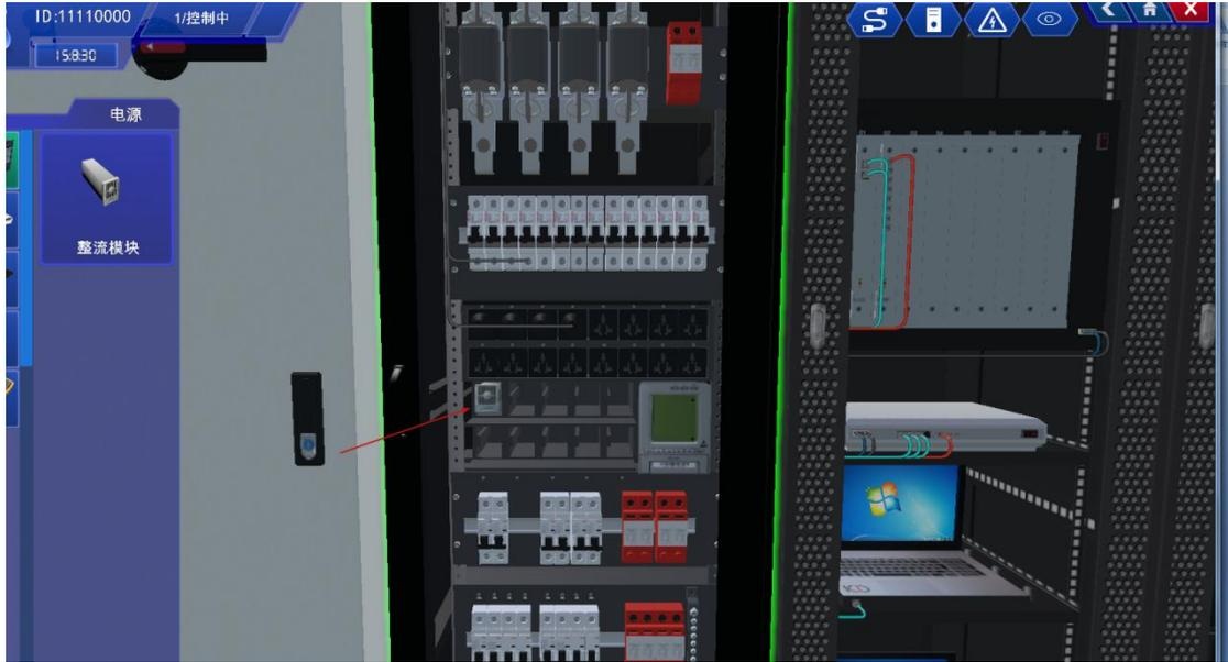
图 2.4.7.1 双击电源柜安装整流模块
