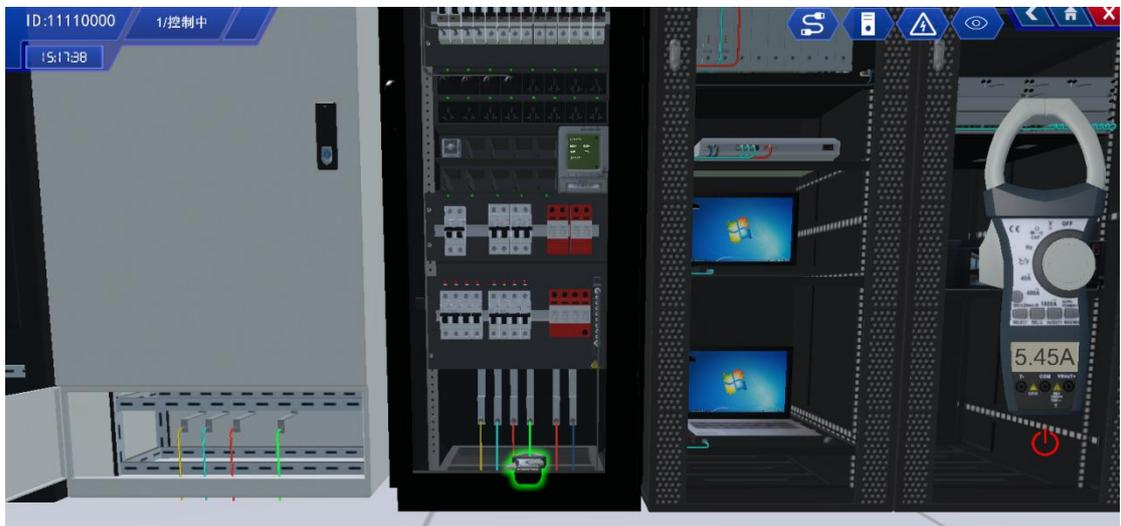
图 2.5.5.3 钳形表测量电流
