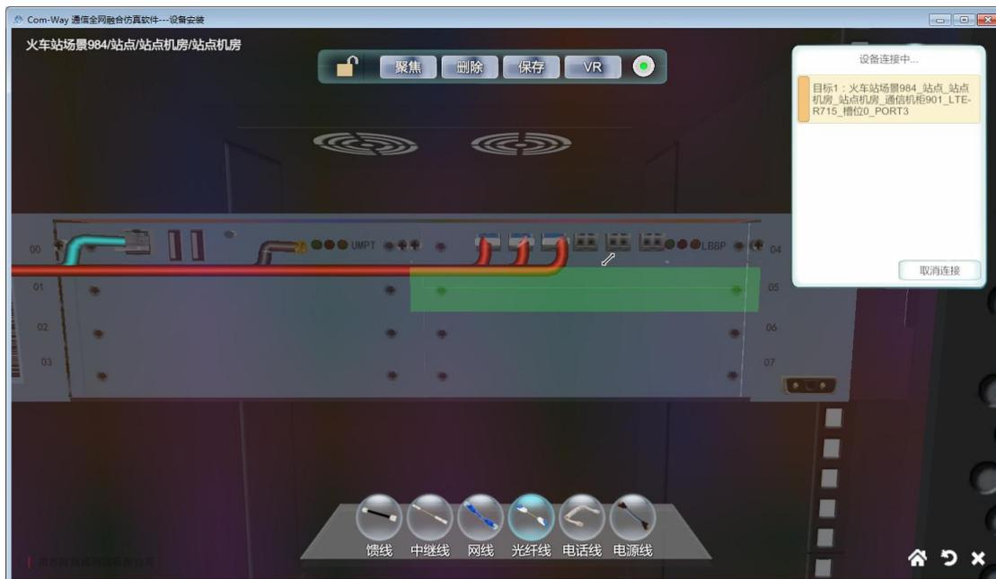
图 2.4.5.6 点击双方端口进行连接
