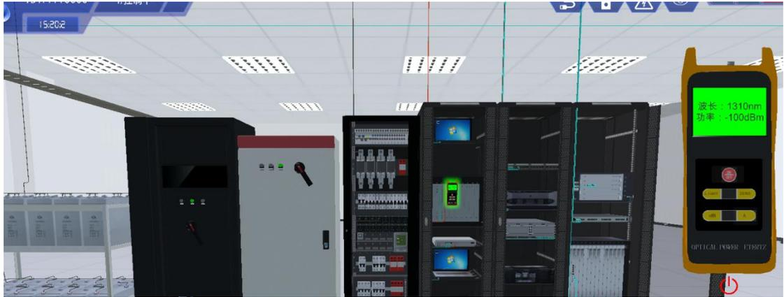
图 2.5.5.5 光功率计测量光纤接口设备
