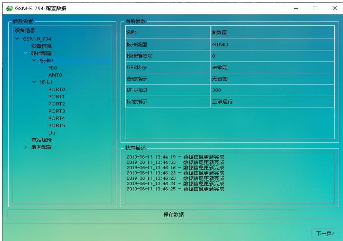
图 8.2.26: 硬件配置-添加 GTMU、GBBP 板卡
