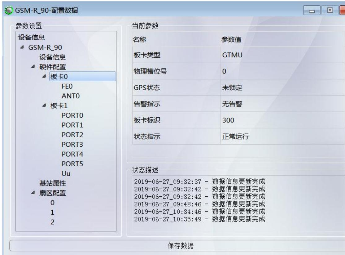
图 8.4.21: 硬件配置-添加 GTMU、GBBP 板卡
