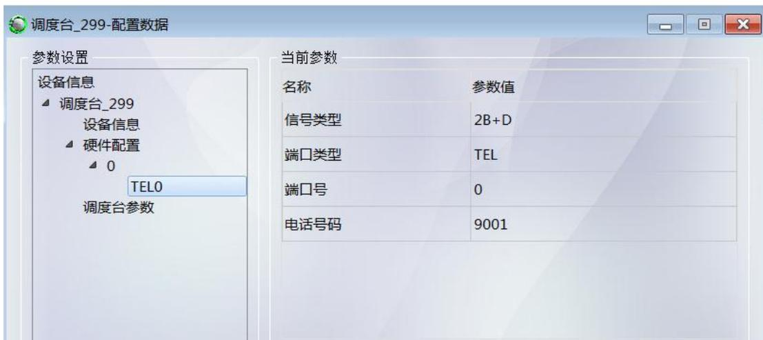
图 8.1.55 调度台号码配置（其他调度台可根据实验规划表配置号码）
