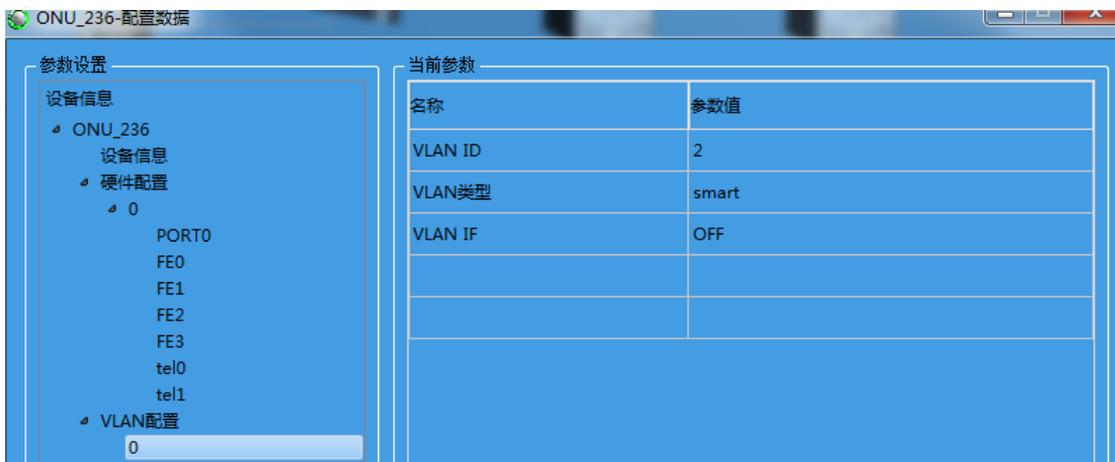
图 8.7.33 添加 ONU 的 VLAN 配置
