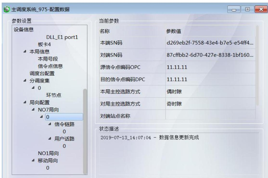
图 8.1.51 添加一个 NO7 局向和移动局向（另一个主调度系统可根据实验规划表配置）
