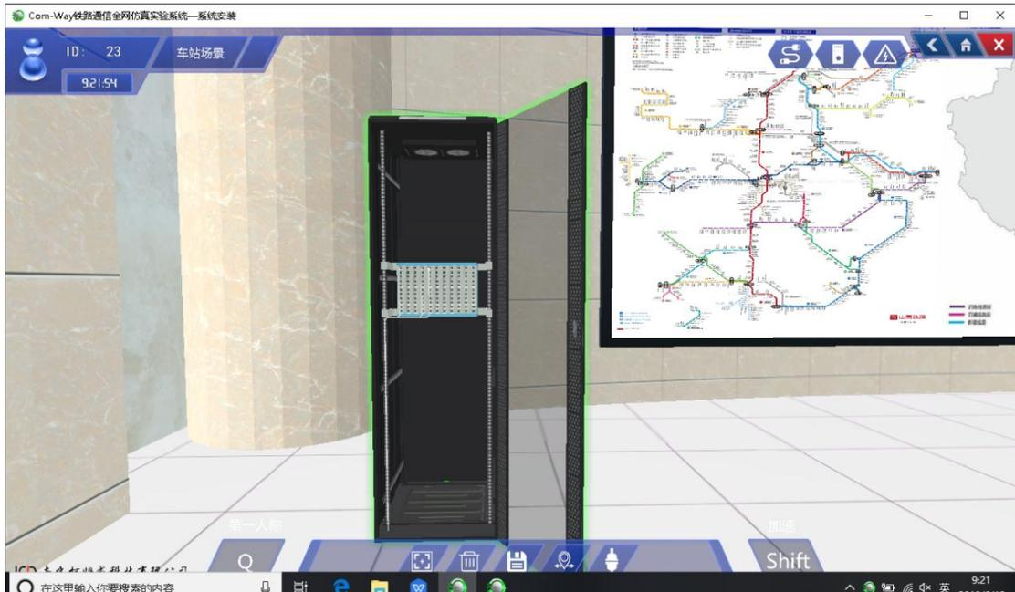
图 8.1.5 在中心调度室安装机柜并添加 MDF 设备
