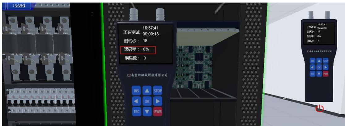
图 8.6.13 测量连接中继线的端口，误码率为 0%（正常）
