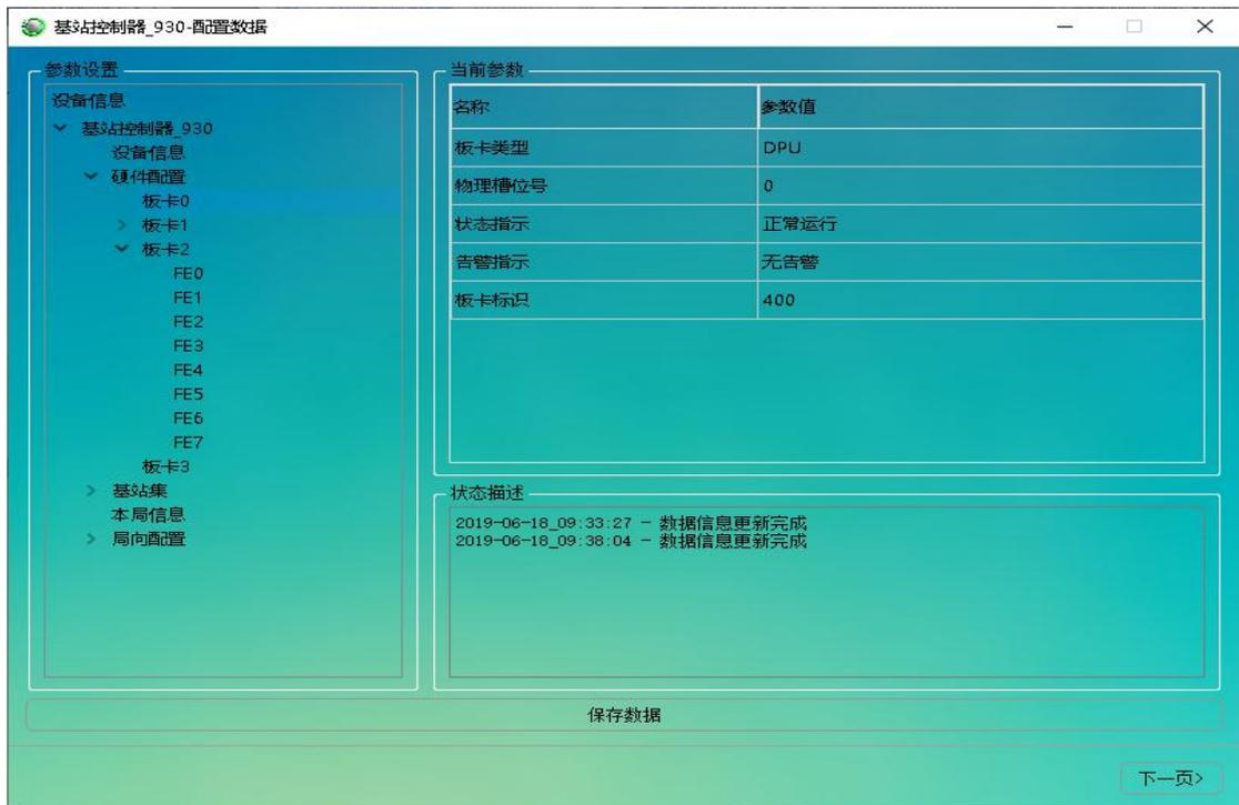
图 8.1.27: 硬件配置—添加 DPU、EIU、FG2、SCU 单板
