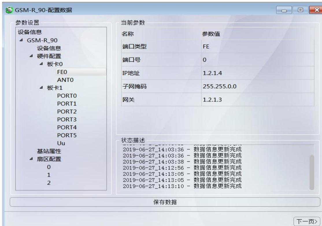
图 8.4.22: 硬件配置-FE0 端口配置
