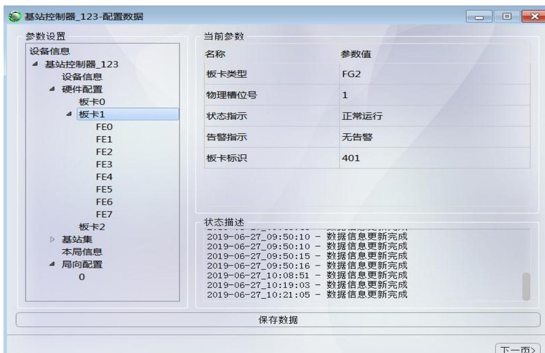
图 8.4.15: 硬件配置-添加 DPU、FG2、SCU 单板
