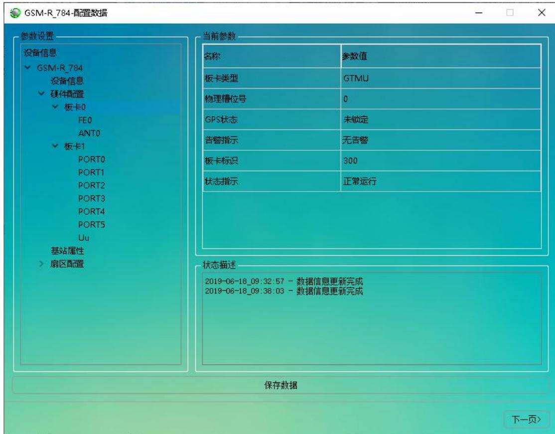
图 8.1.32: 硬件配置—添加 GTMU、GBBP 单板
