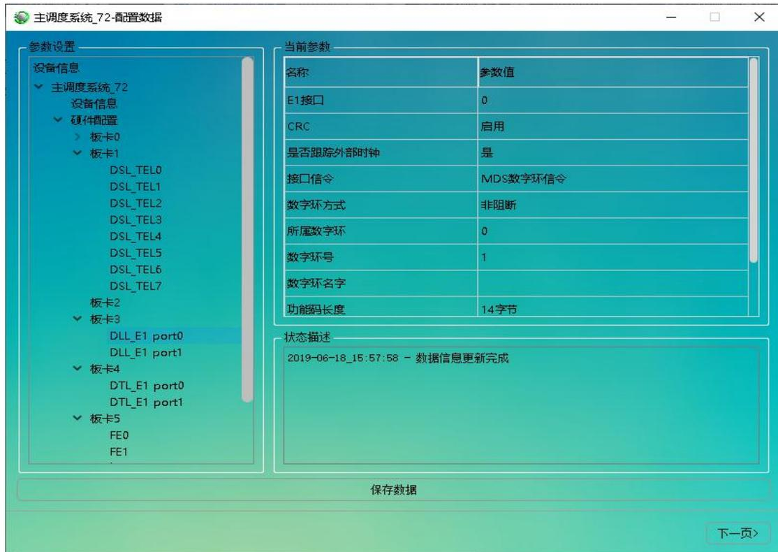
图 8.5.14: 硬件配置—DLL 单板配置
