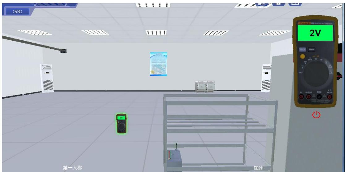
图 8.6.3 将万用表红表笔连接正极，黑表笔连接负极，万用表显示 2V
