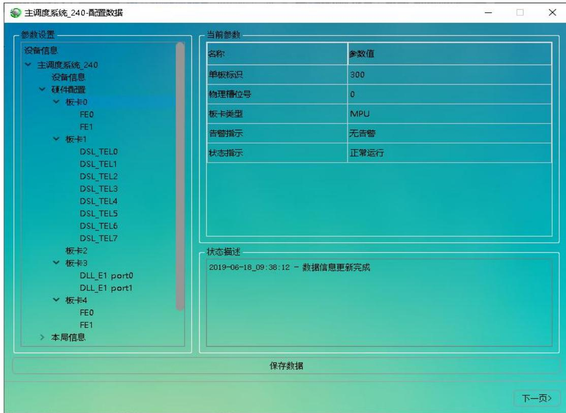
图 8.1.10 硬件配置—添加 MPU、DSL、RNG、DFE、DLL 单板
