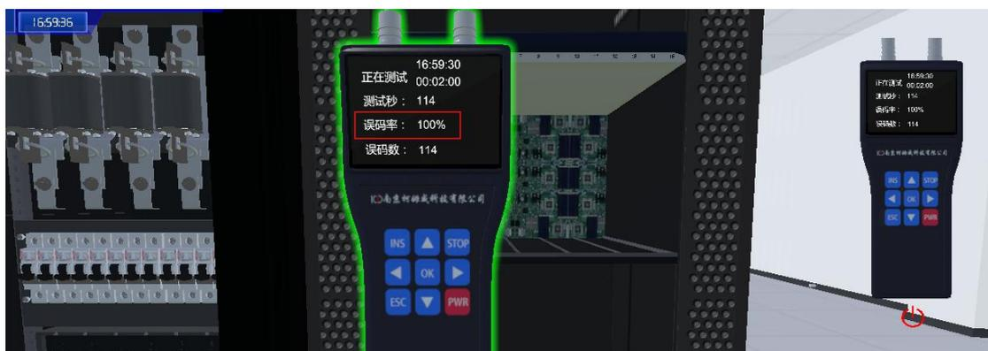
图 8.6.14 测量未连接中继线的端口，误码率为 100%（异常）
