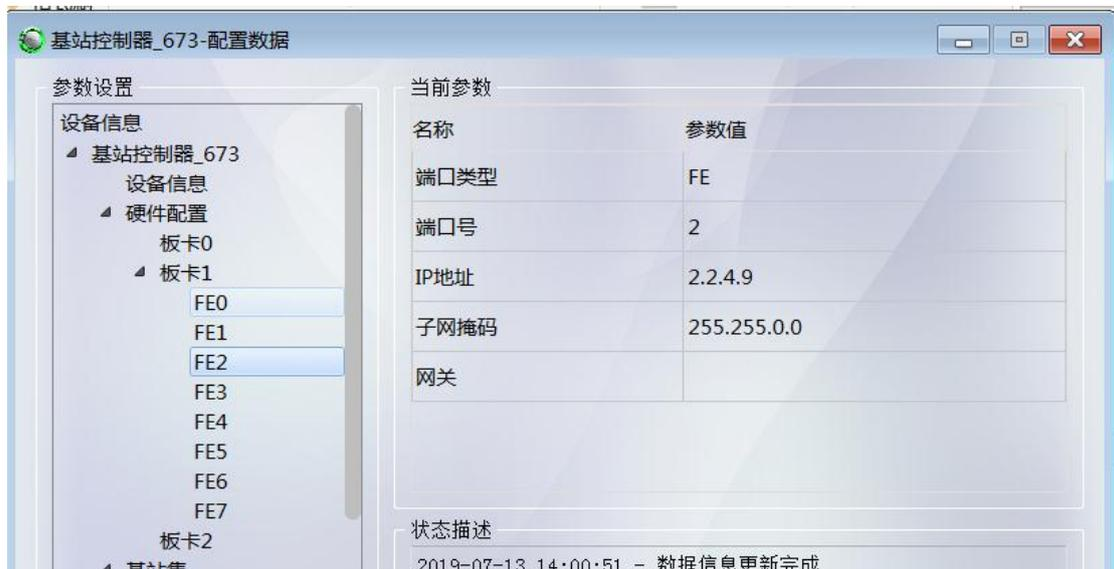
图 8.1.41 FE-FE2 的端口配置，可根据规划表进行配置
