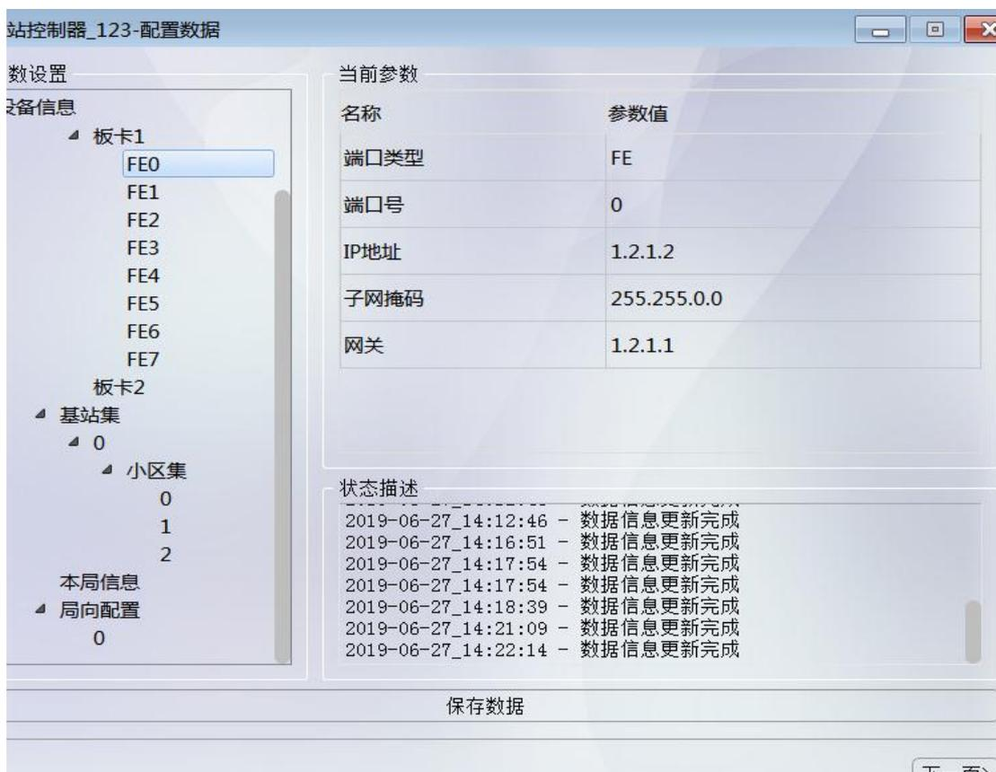
图 8.4.16: FE0 端口配置
