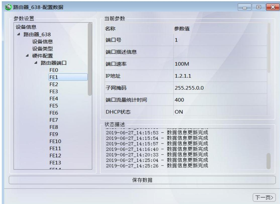
图 8.4.10: 硬件配置-FE1 端口配置
