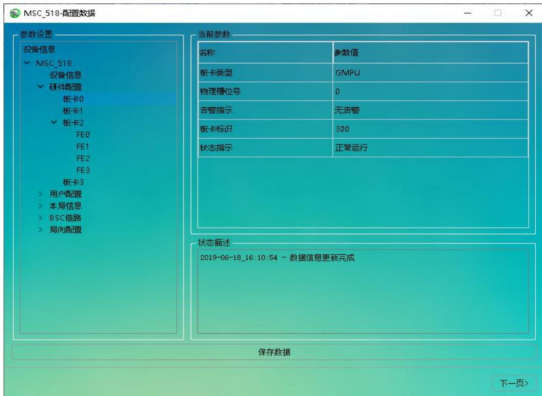
图 8.5.30: 硬件配置—添加 GMPU、GLPP、GFEU、GCBD 单板
