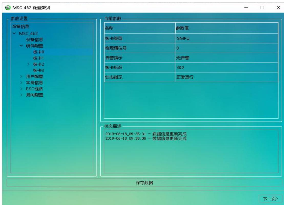
图 8.1.19: 硬件配置—添加 GMPU、GLLP、GFEU、GCBD 单板
