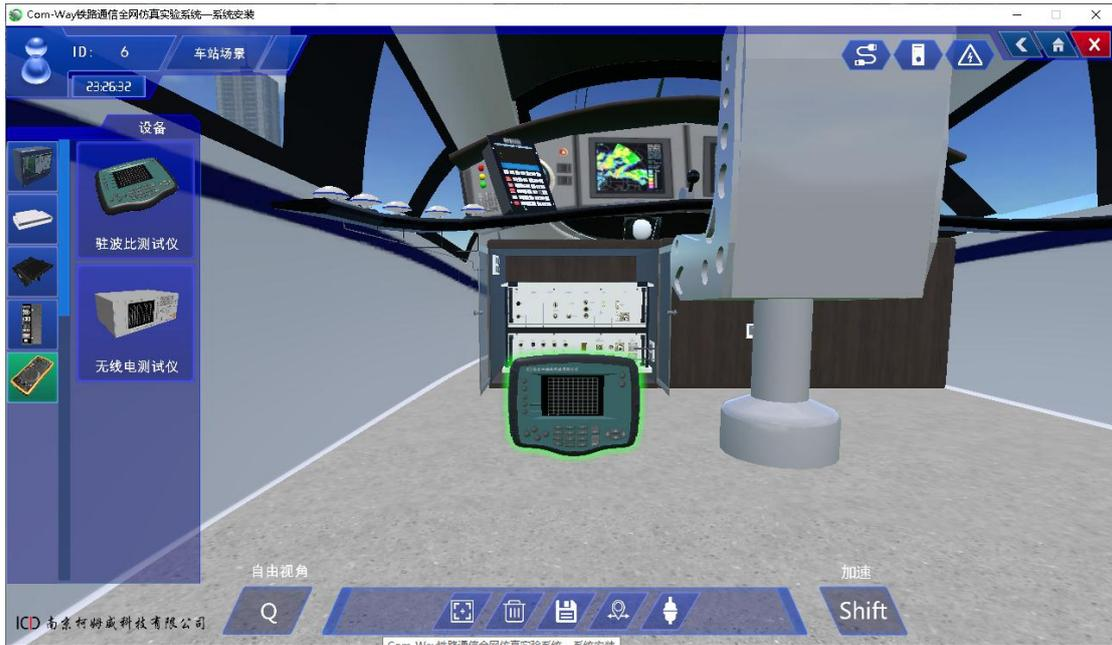
图 8.6.19: 添加驻波比测试仪器
