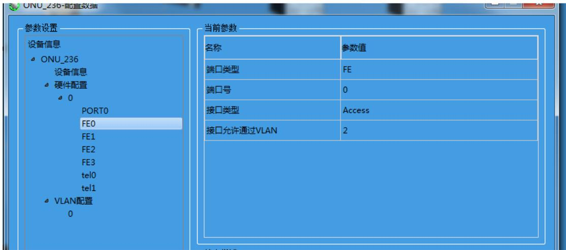
图 8.7.32 ONU 设备的 FE0-FE3 的 VLAN 为 2
