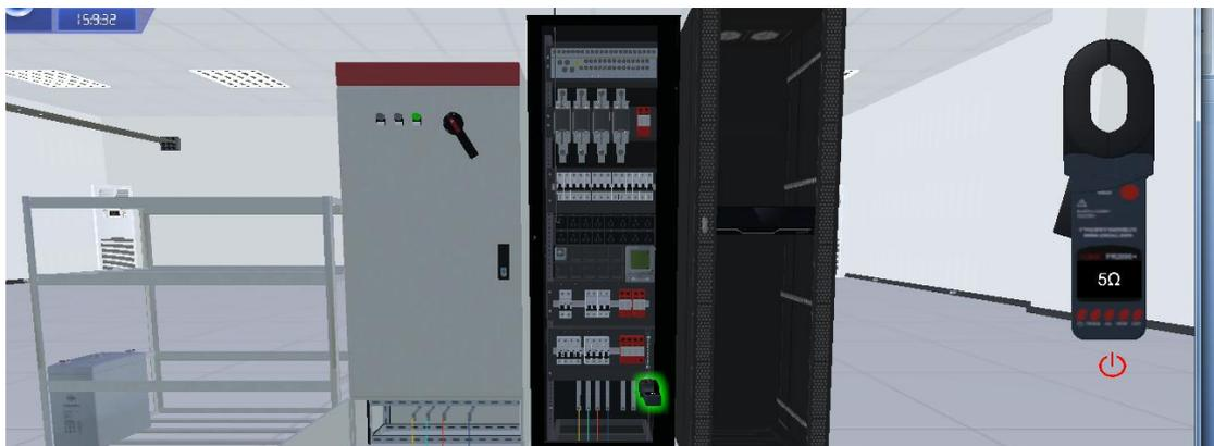
图 8.6.6 测量没有接地线的端口，地阻仪显示数据为 5，则为不正常
