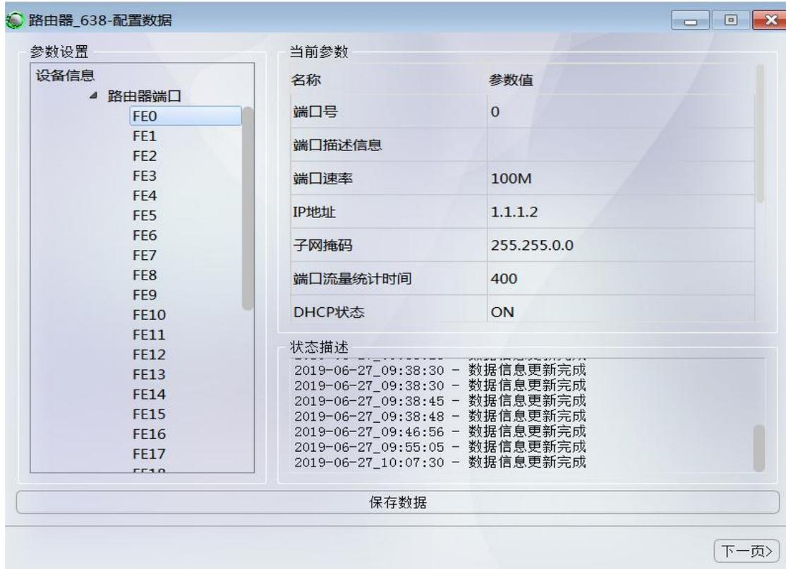
图 8.4.9: 硬件配置-FE0 端口配置
