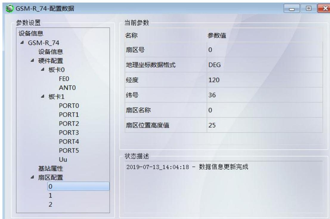
图 8.1.45 添加三个扇区（另一个 GSM-R 可根据规划表配置）
