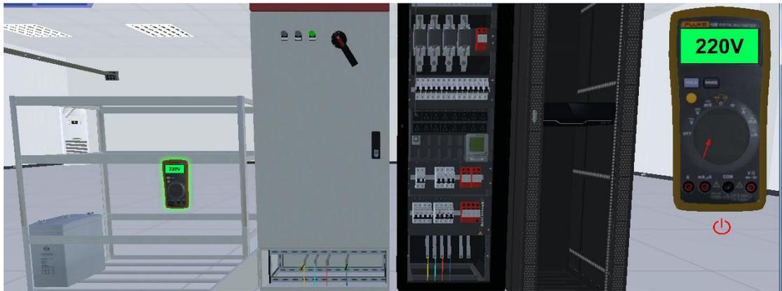
图 8.6.4 万用表与动力柜端口连接，将万用表调节到测交流电处，显示 220V
