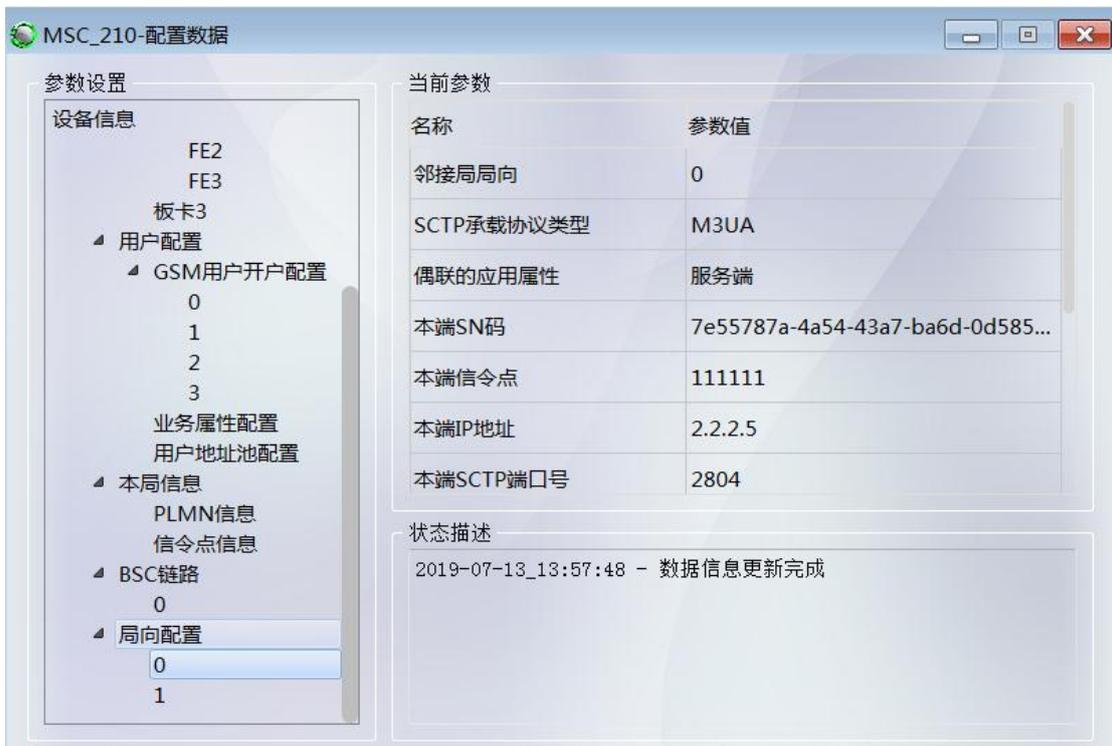
图 8.1.39 添加两个局向配置（两个主调度系统之间的局向）
