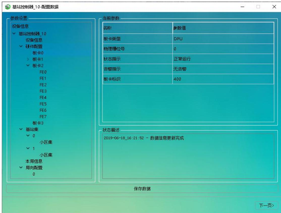
图 8.5.37：硬件配置—添加 DPU、EIU、FG 2、SCU 单板
