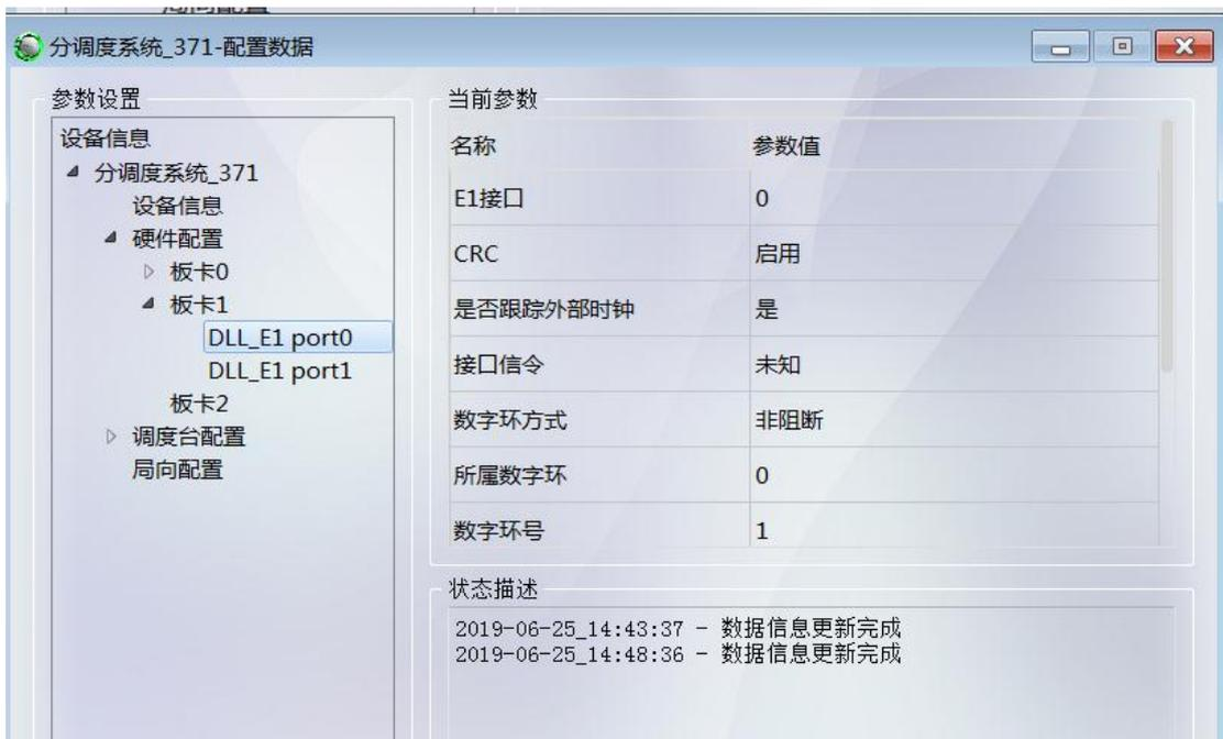
图 8.3.16:板卡 DLL 配置 (MDSSUB 2 的配置可根据规划表完成)
