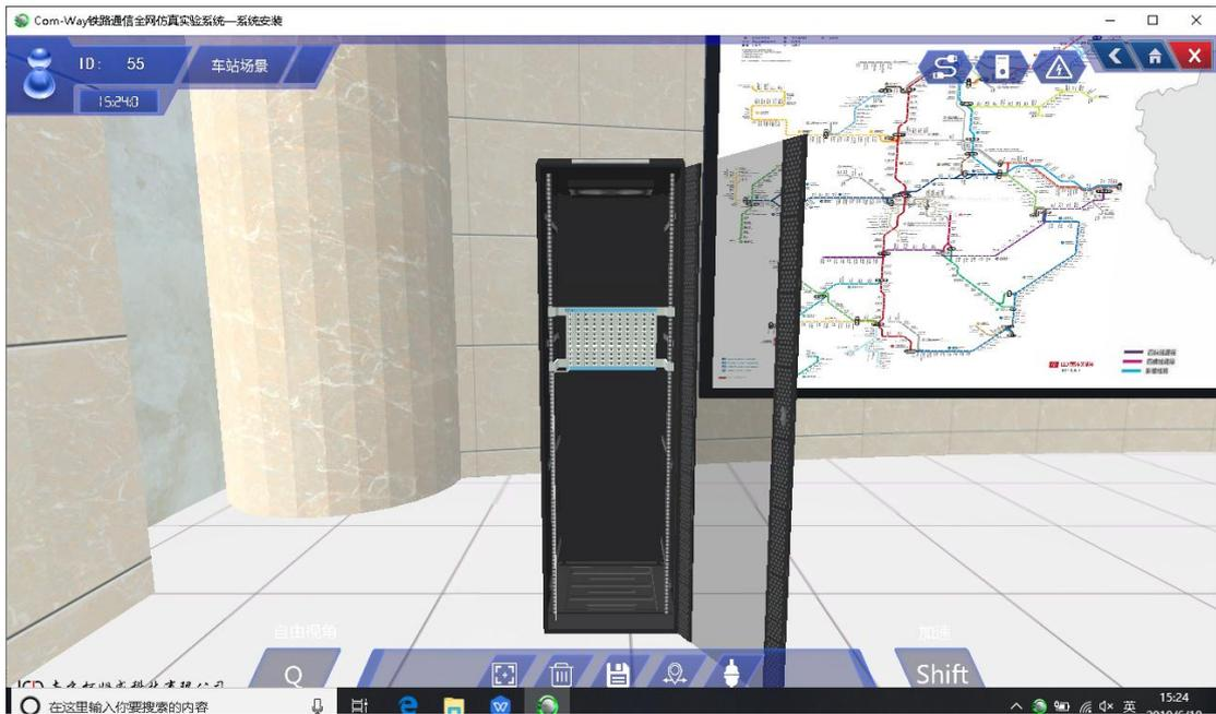
图 8.5.7 在中心调度室安装机柜并添加 MDF 设备
