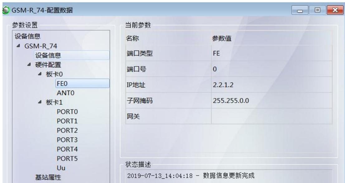
图 8.1.44 添加 GTMU、GBBP 单板，并对 FE0 端口配置
