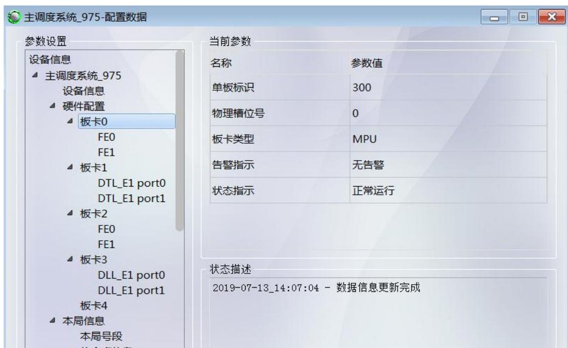
图 8.1.47 添加 MPU、DTL、DFE、DLL 单板
