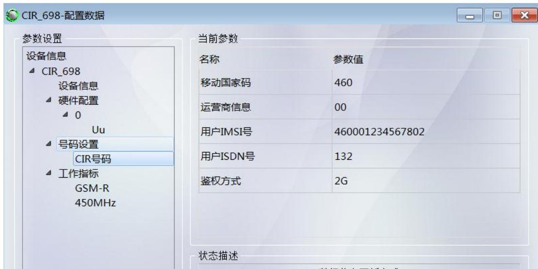
图 8.1.46 号码配置（其他三个可根据规划表配置号码）
