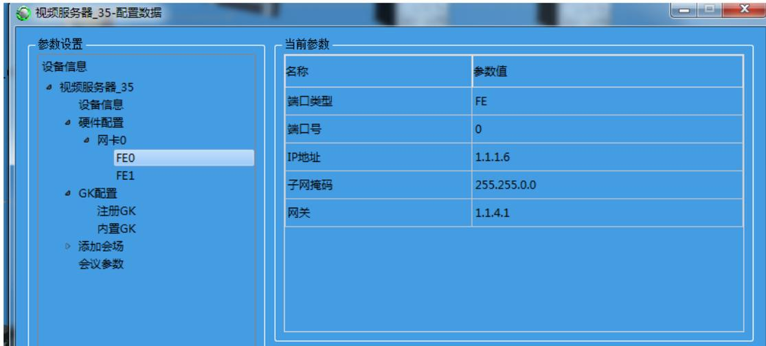
图 8.7.18 配置视频服务器的 FE0 的 IP 地址
