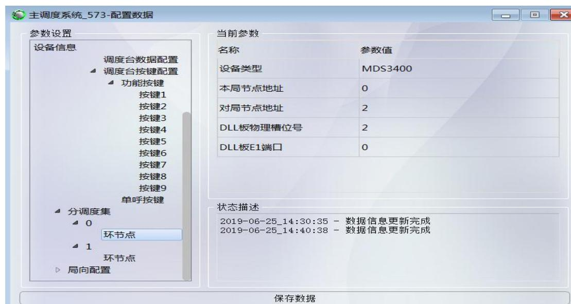
图 8.3.14: MDS1 分调度集环节点配置 0 (MDS1 分调度集配置 0 配置与其类似, 根据规划表可完成配置)
