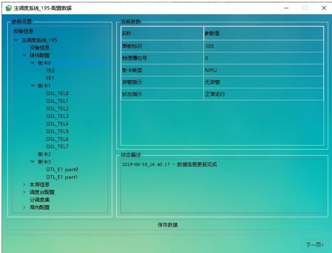
图 8.5.48: 硬件配置—添加 MPU、DSL、DTL、RNG 单板
