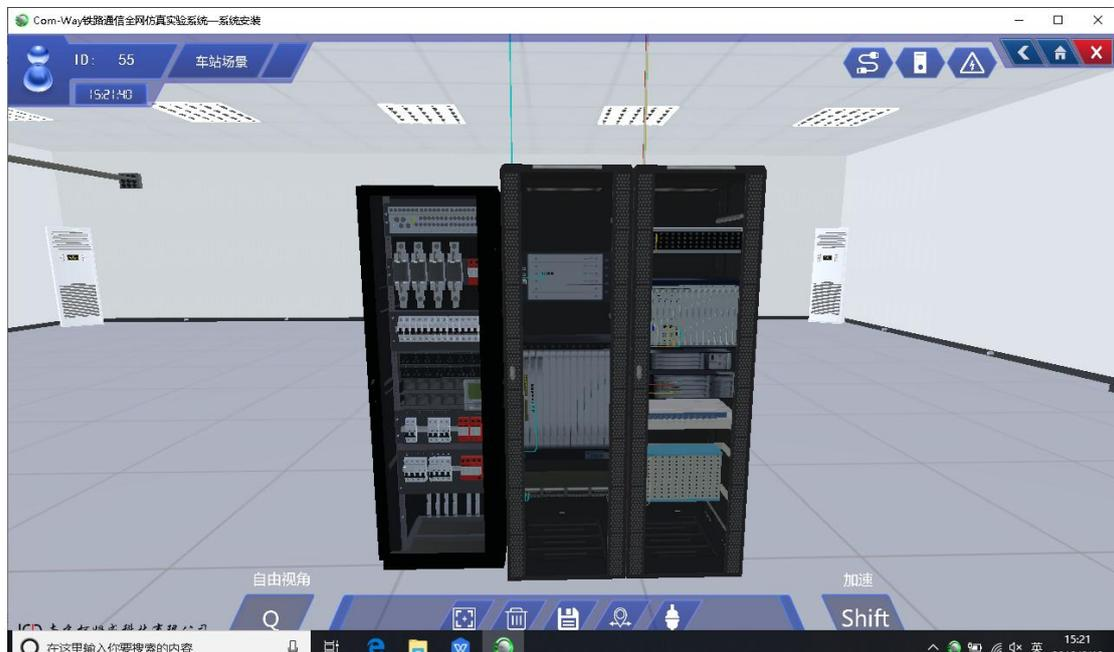
图 8.5.2 在中心机房里添加电源柜、机柜
