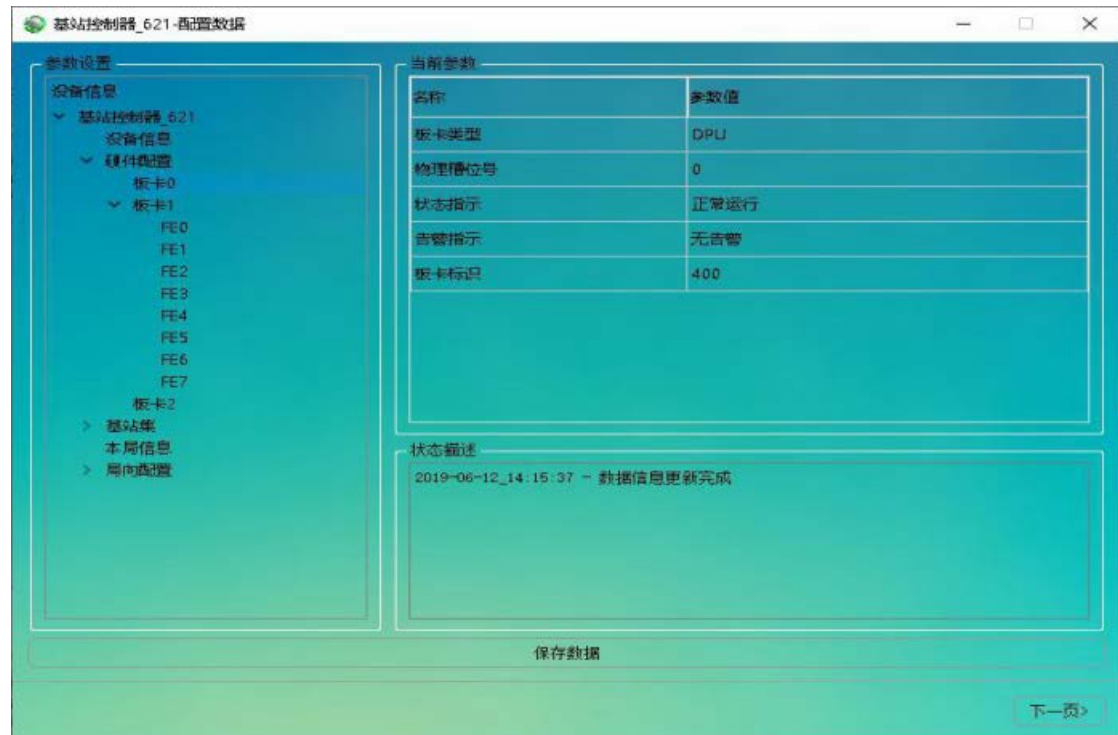
图 5.4.10: 硬件配置—添加 DPU、FG2、SCU 单板
