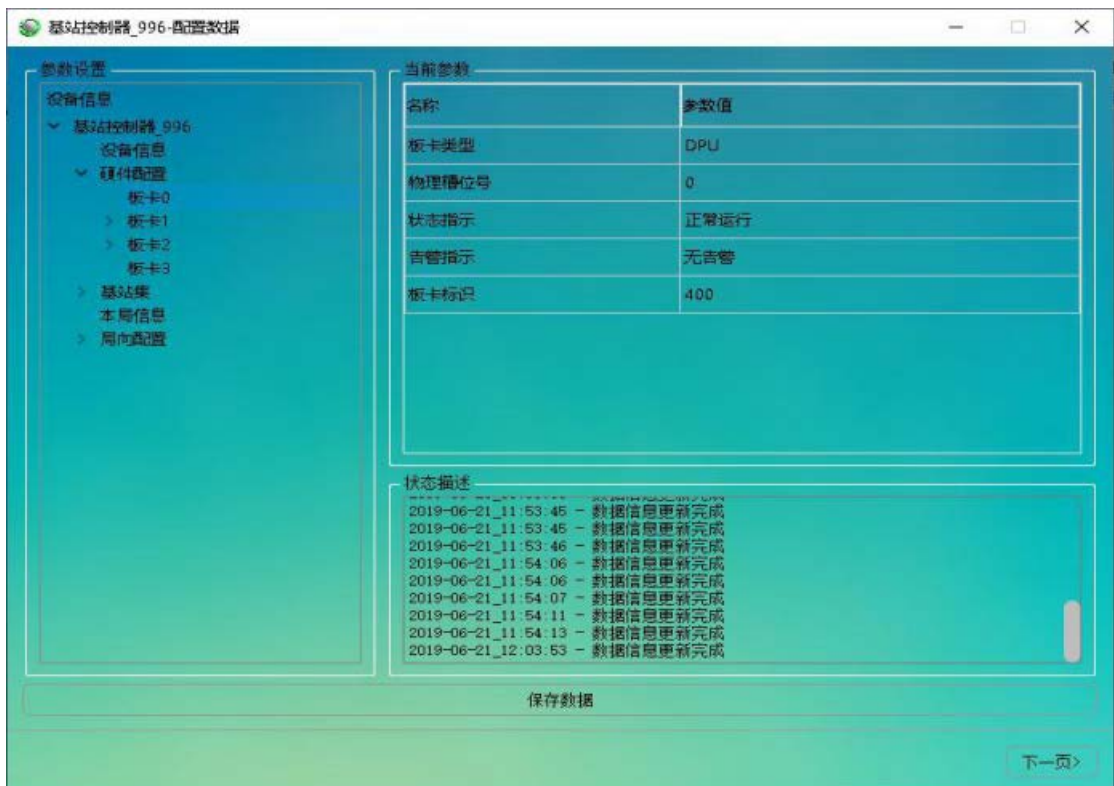
图 5.5.13: 硬件配置—添加 DPU、FG2、SCU 单板
