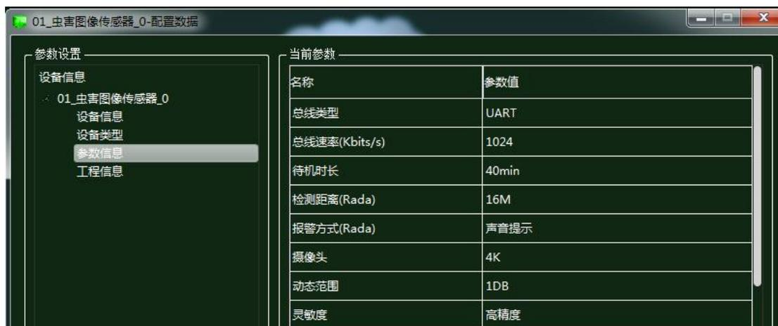
图 1.15.21 虫害图像传感器参数信息配置
