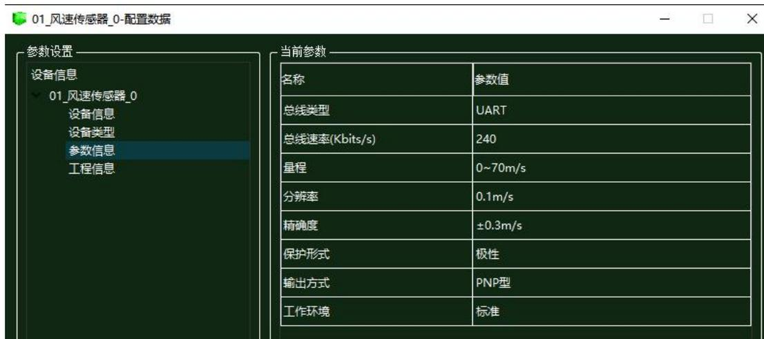
图 1.8.23 风速传感器参数信息配置
