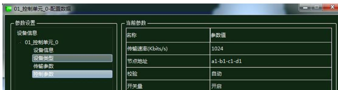
图 1.18.39 控制单元控制参数配置
