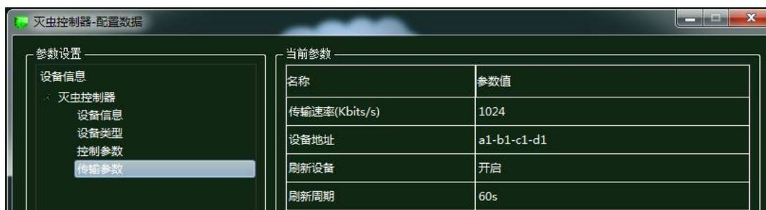
图 1. 15. 24 灭虫控制器传输参数配置
