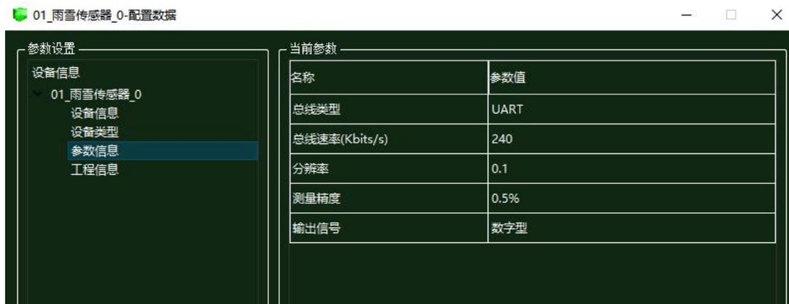
图 1.8.22 雨雪传感器参数信息配置
