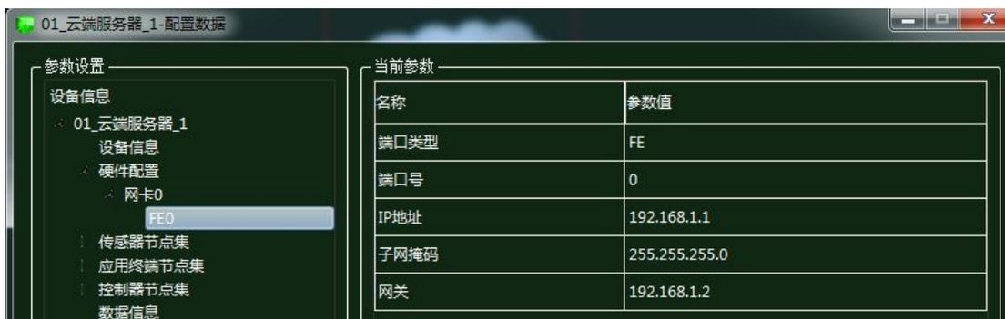
图 1.13.19 云端服务器网卡配置
