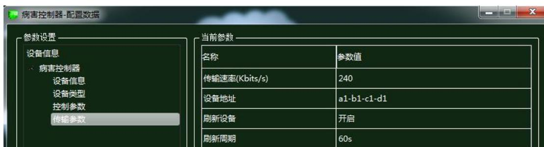
图 1. 14. 35 病害控制器传输参数配置
