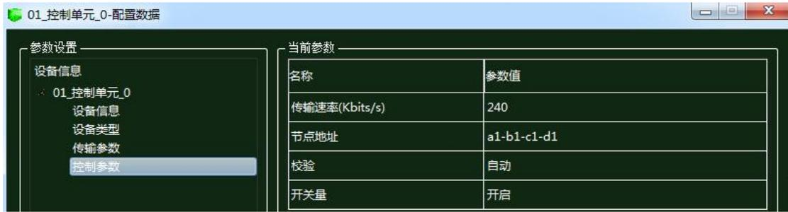
图 1.13.28 控制单元控制参数配置
