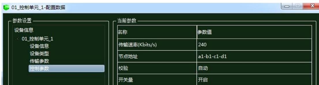
图 1.10.27 控制单元控制参数配置
