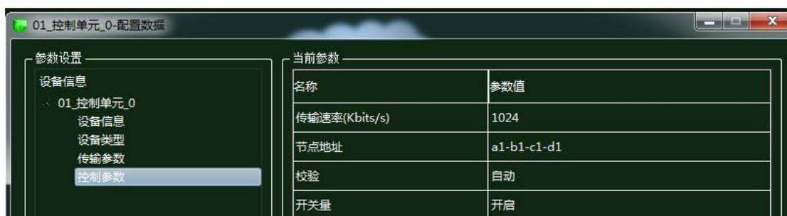
图 1.9.26 控制单元控制参数配置
