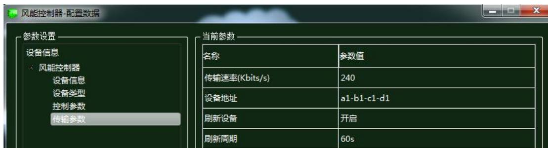
图 1. 14. 34 风能控制器传输参数配置
