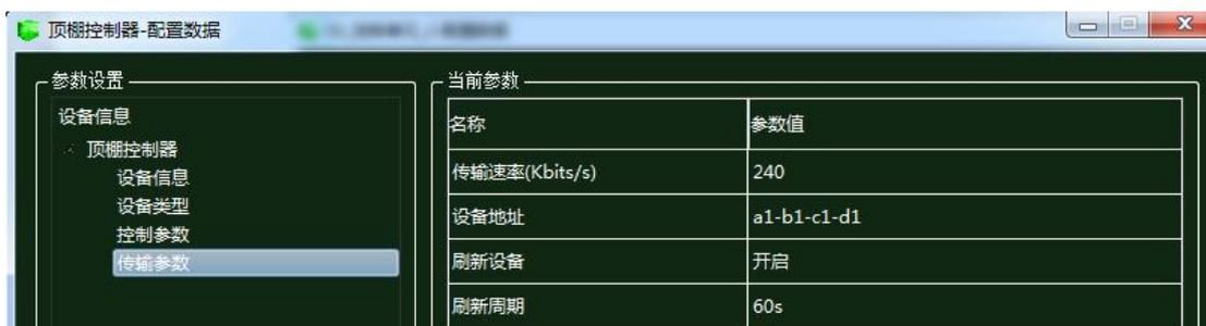
图 1.16.65 顶棚控制器传输参数配置
