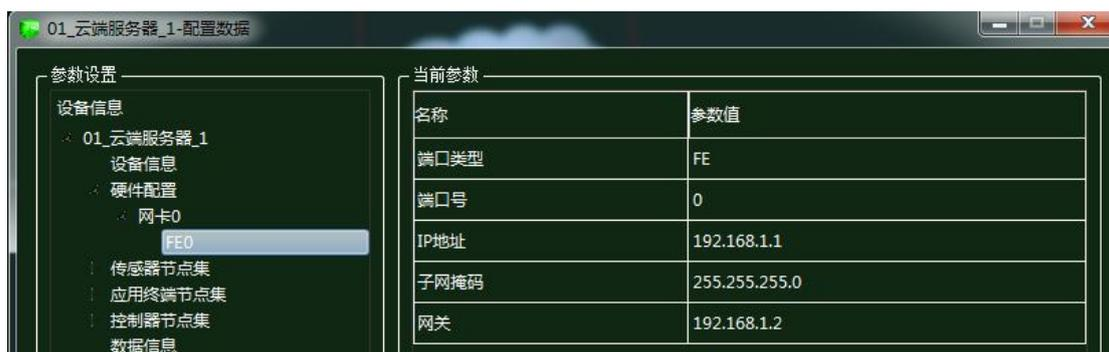
图 1. 10. 19 云端服务器硬件 FE0 配置
