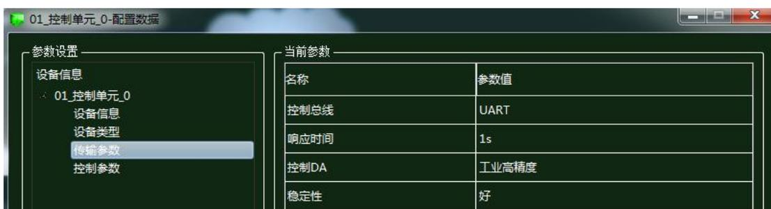
图 1.13.27 控制单元传输参数配置
