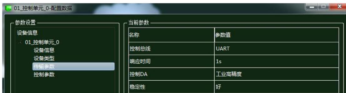
图 1.9.25 控制单元传输参数配置
