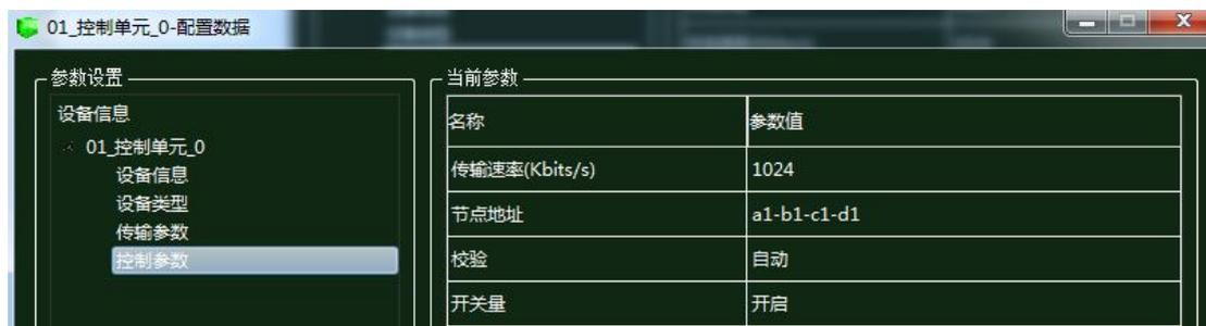
图 1.16.55 控制单元控制参数配置
