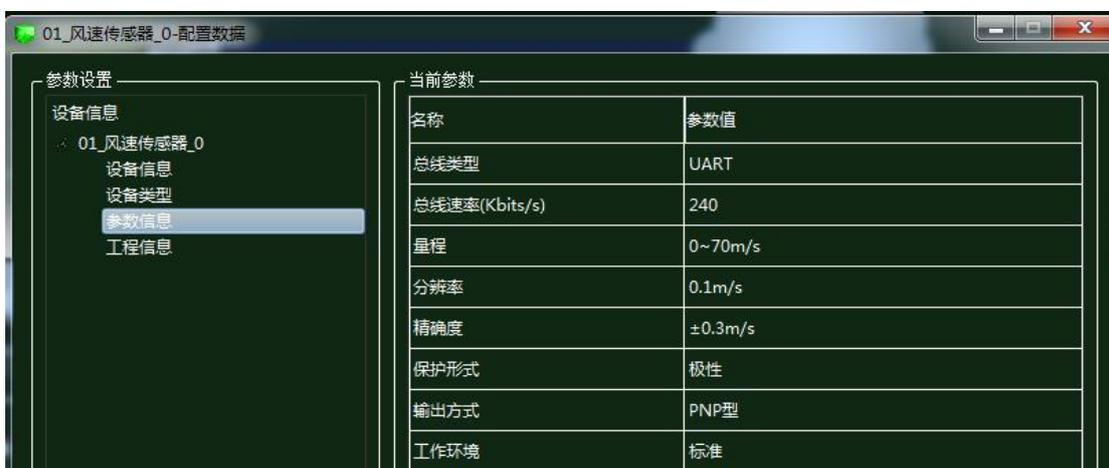
图 1. 18. 49 风速传感器参数信息配置
