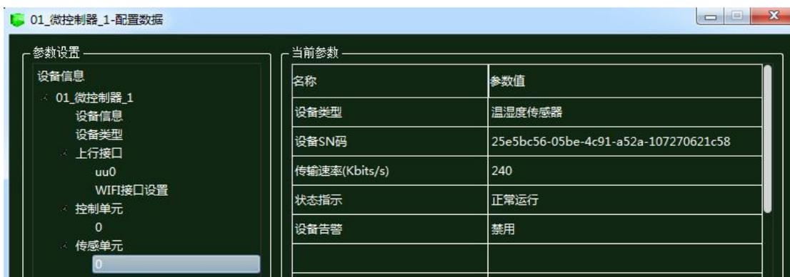
图 1.10.25 微控制器传感单元配置
