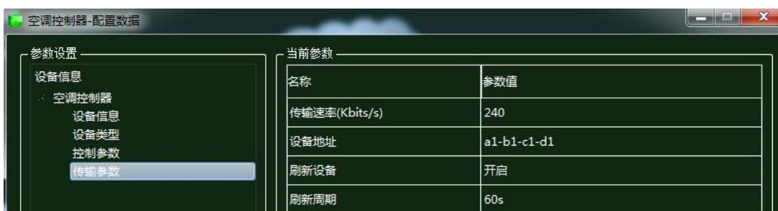
图 1.18.55 空调控制器传输参数配置
