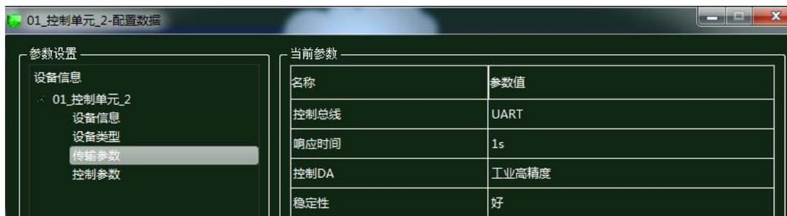
图 1. 18. 65 控制单元传输参数配置
