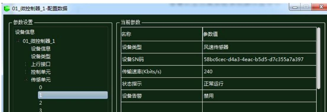
图 1.18.45 微控制器传感单元 1 配置
