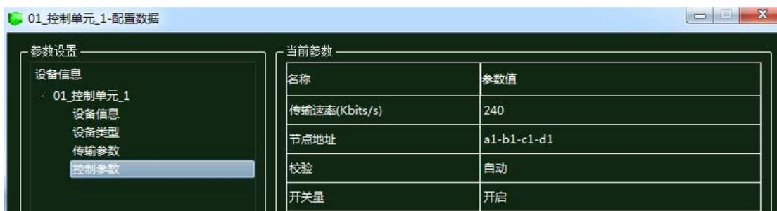
图 1.11.28 控制单元控制参数配置
