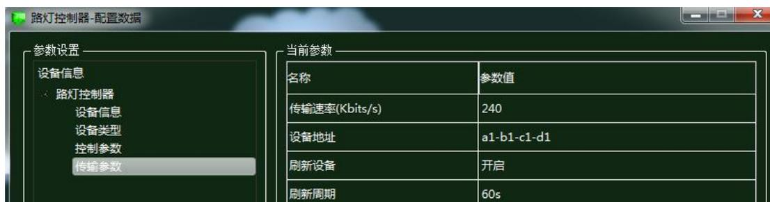
图 1.9.28 路灯控制器传输参数配置
