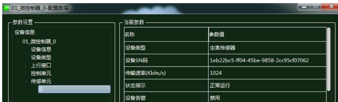
图 1.15.20 微控制器传感单元配置
