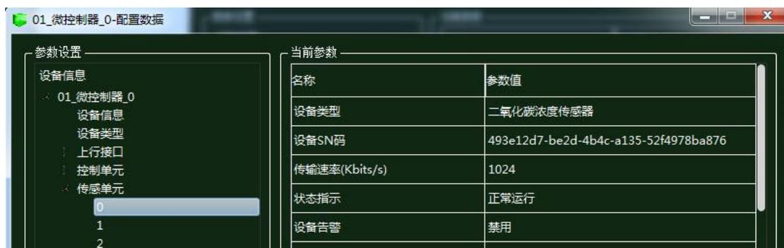
图 1.18.32 微控制器传感单元 0 配置
