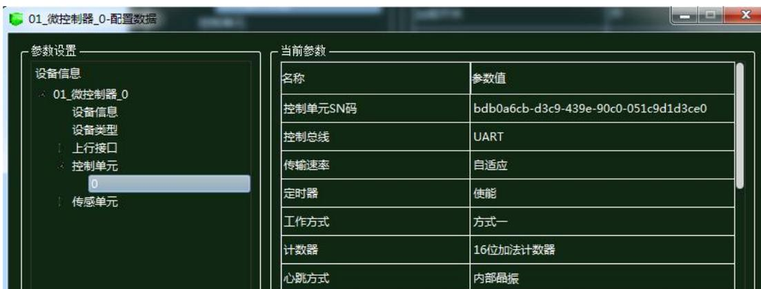
图 1.12.26 微控制器控制单元配置
