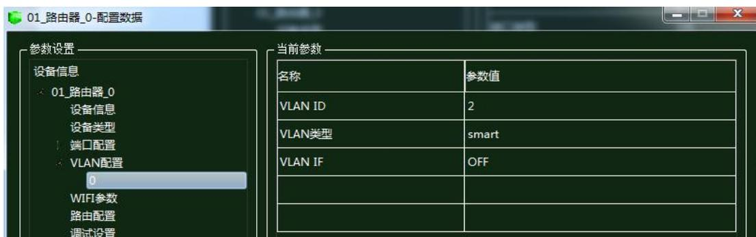
图 1. 10. 17 路由器 VLAN 参数配置
