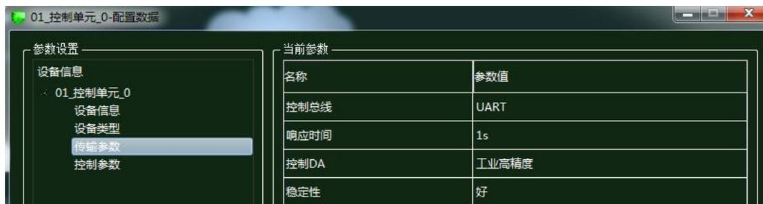
图 1.15.22 控制单元传输参数配置
