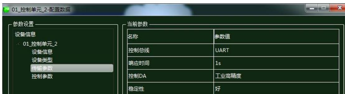
图 1.16.63 控制单元传输参数配置
