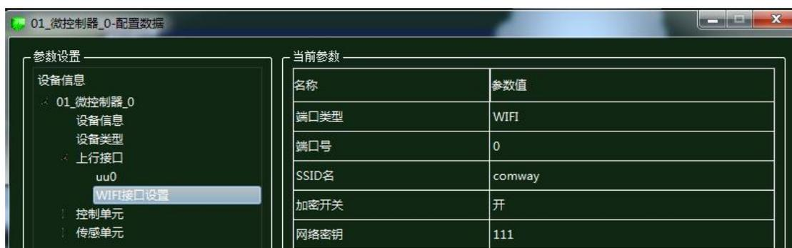
图 1.18.30 微控制器的 WIFI 接口配置
