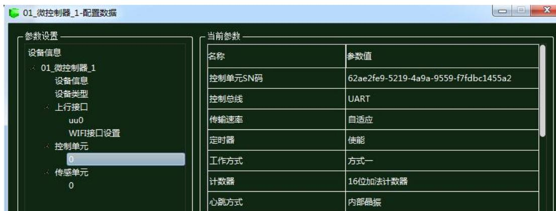
图 1.10.24 微控制器控制单元配置
