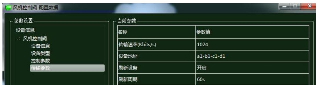
图 1.16.56 风机控制阀传输参数配置
