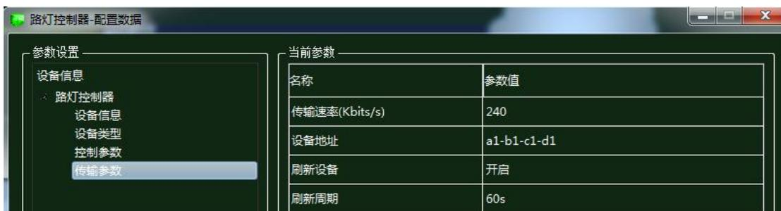
图 1.18.56 路灯控制器传输参数配置
