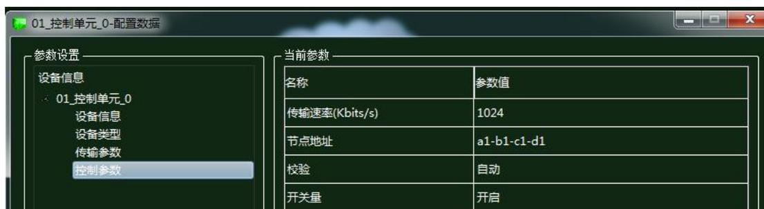
图 1.15.23 控制单元控制参数配置
