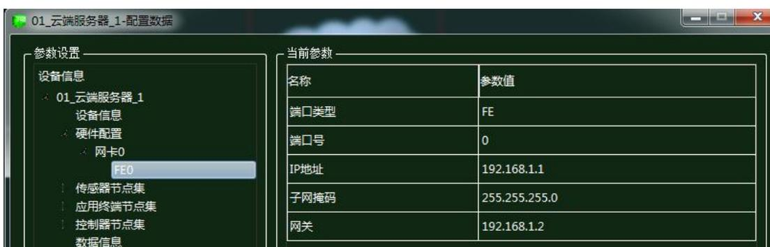
图 1.11.20 云端服务器硬件 FE0 配置
