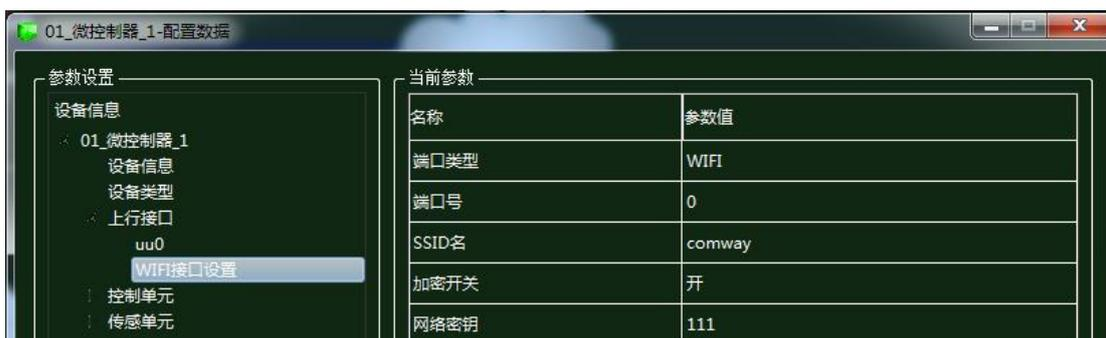
图 1.18.42 微控制器的WIFI接口配置
