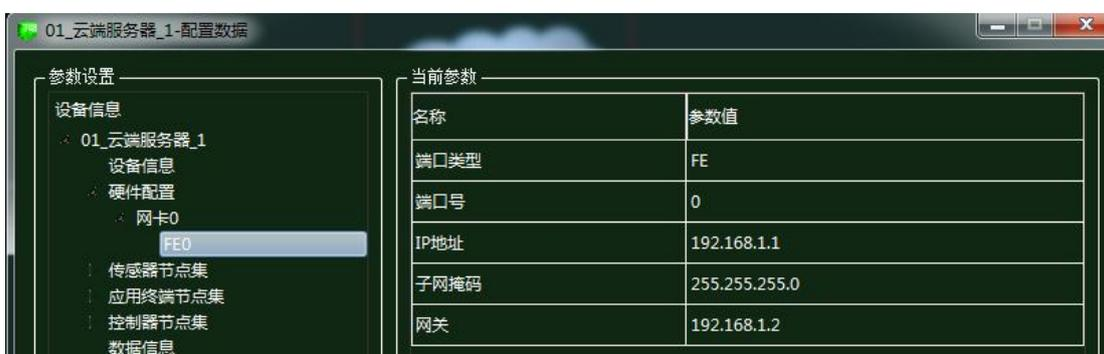
图 1.14.20 云端服务器网卡配置
