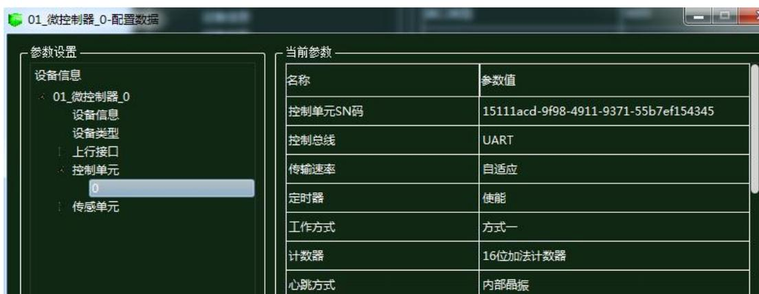
图 1.14.28 微控制器控制单元配置
