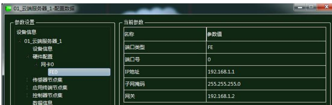
图 1.12.20 云端服务器 FE0 配置
