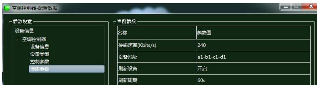
图 1.16.48 空调控制器传输参数配置
