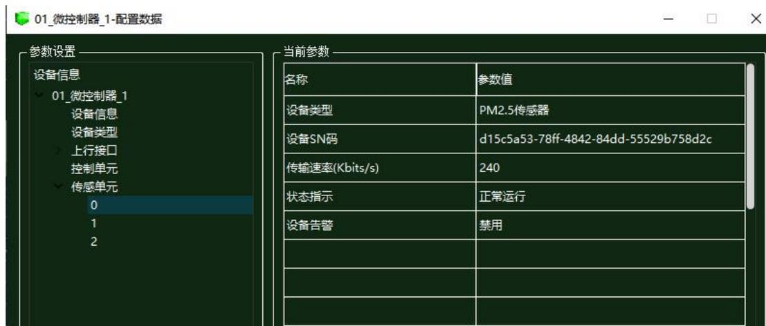
图 1.8.19 微控制器传输单元 0 参数配置
