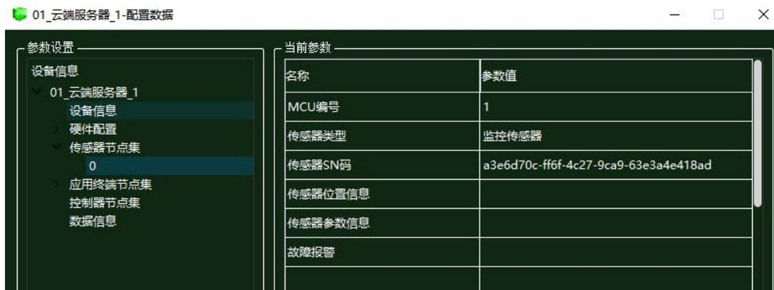
图 1.7.15 云端服务器传感器节点配置
