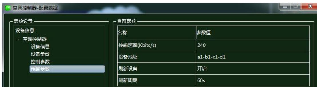
图 1.10.29 空调控制器传输参数配置
