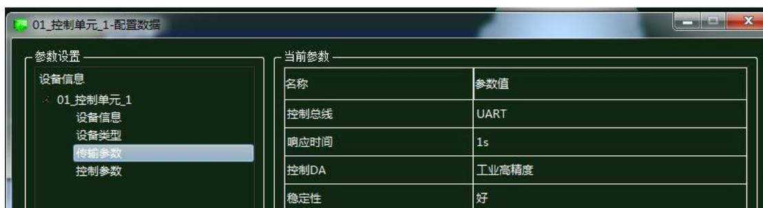
图 1.18.52 控制单元传输参数配置
