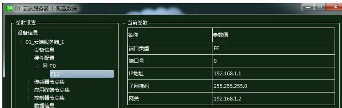
图 1.16.30 云端服务器网卡配置
