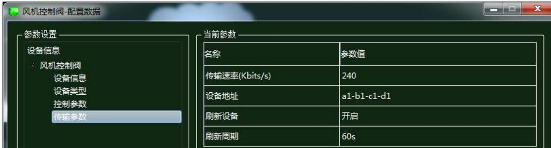
图 1.13.29 风机控制阀传输参数配置
