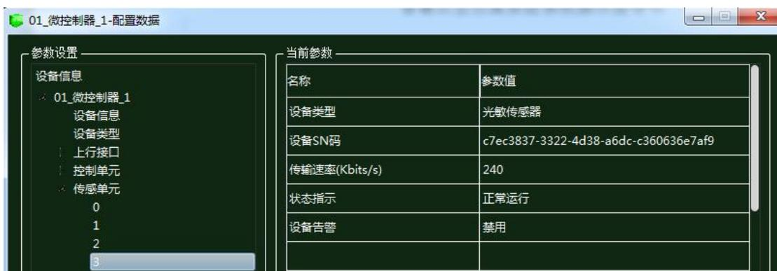
图 1. 18. 47 微控制器传感单元 3 配置
