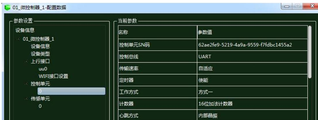
图 1.11.25 微控制器控制单元配置
