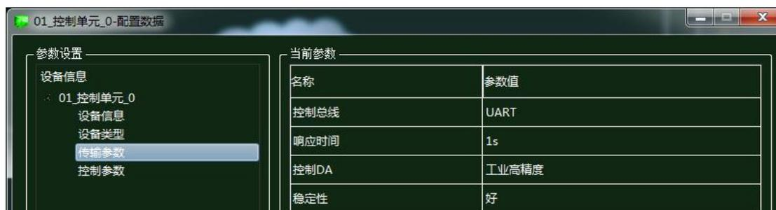
图 1.12.28 控制单元传输参数配置
