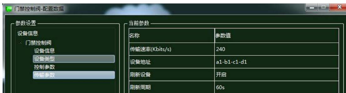
图 1.9.27 门禁控制阀传输参数配置
