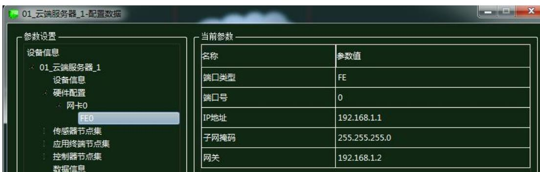
图 1.9.10 云端服务器网卡配置
