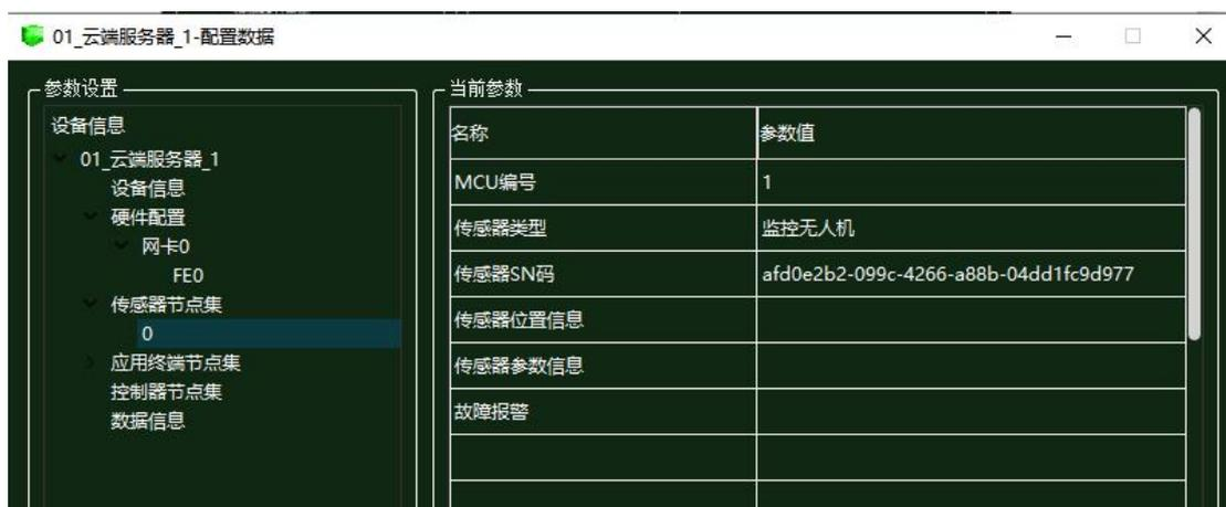
图 1.6.14 云端服务器传感器节点配置
