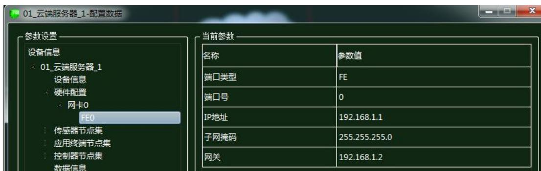
图 1.7.14 云端服务器硬件配置
