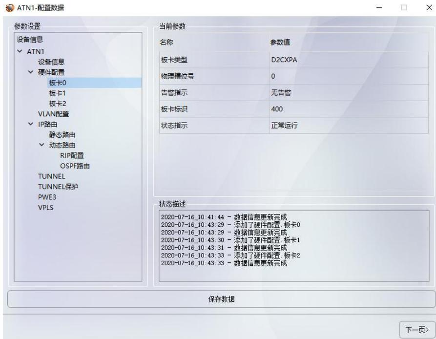
图 2.12-ATN1 设备添加单板（D1EM4F、D1EM4T、D2CXPA）
