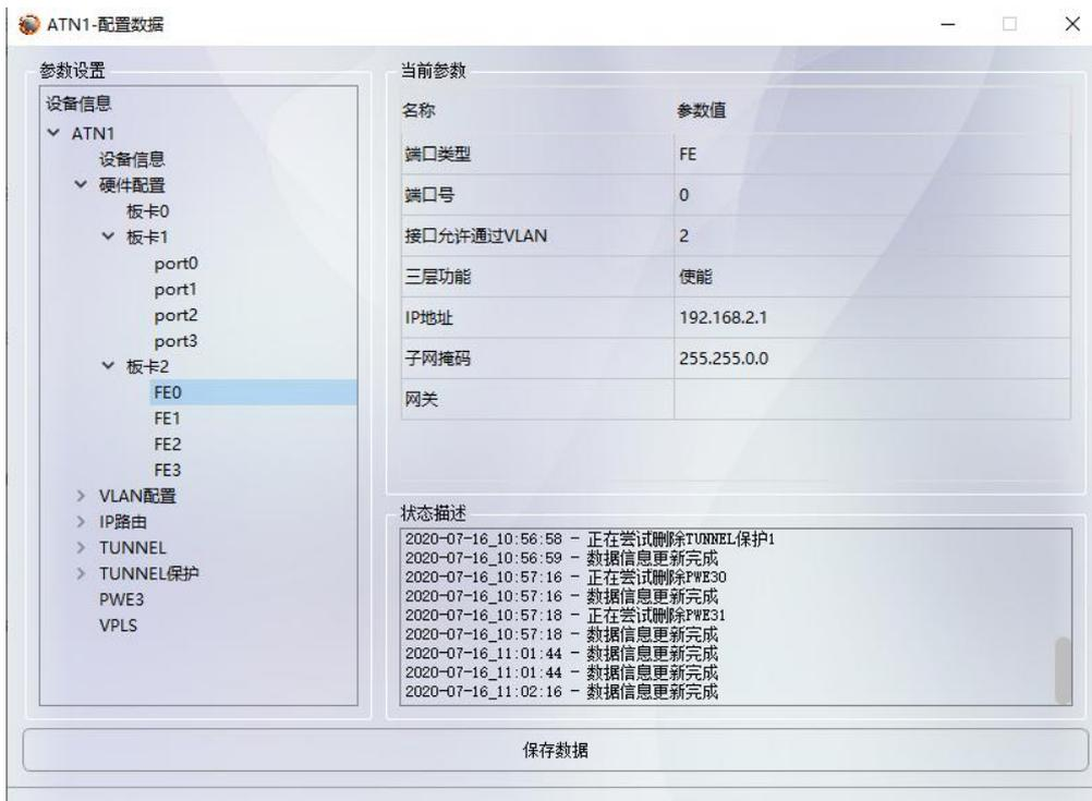
图 4.13 FE 端口参数配置
