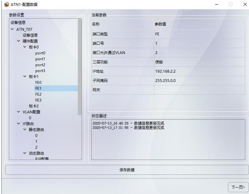
图 5.16 配置 ATN1 的板卡 1 接口允许通过的 VLAN 以及 IP 地址和子网掩码
