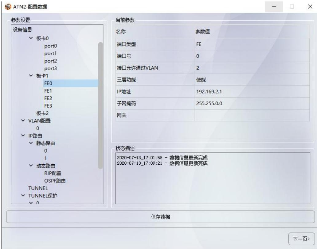
图 5.22 ATN2 设备添加单板（并且配置板卡 1 的 FE0 端口参数）
