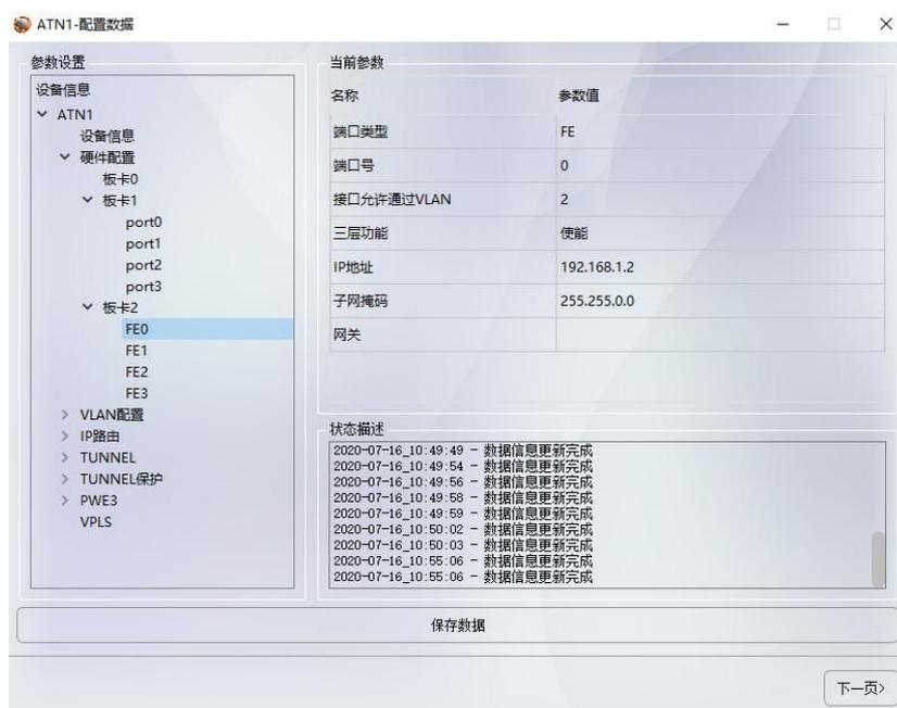
图 3.13 FE0 端口配置
