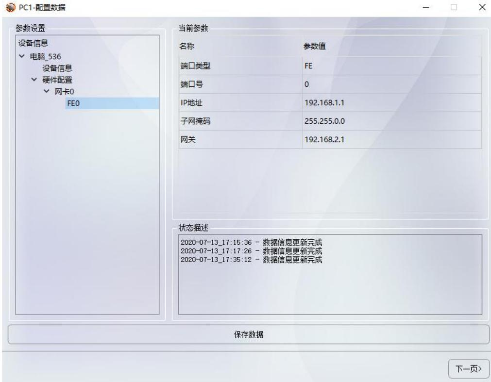
图 5.39PC1 参数配置，PC2-5 可参考数据规划表
