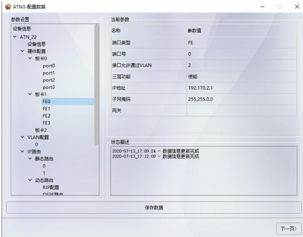
图 5.28 ATN3 设备添加单板（并配置板卡 1 的 FE0 端口参数）
