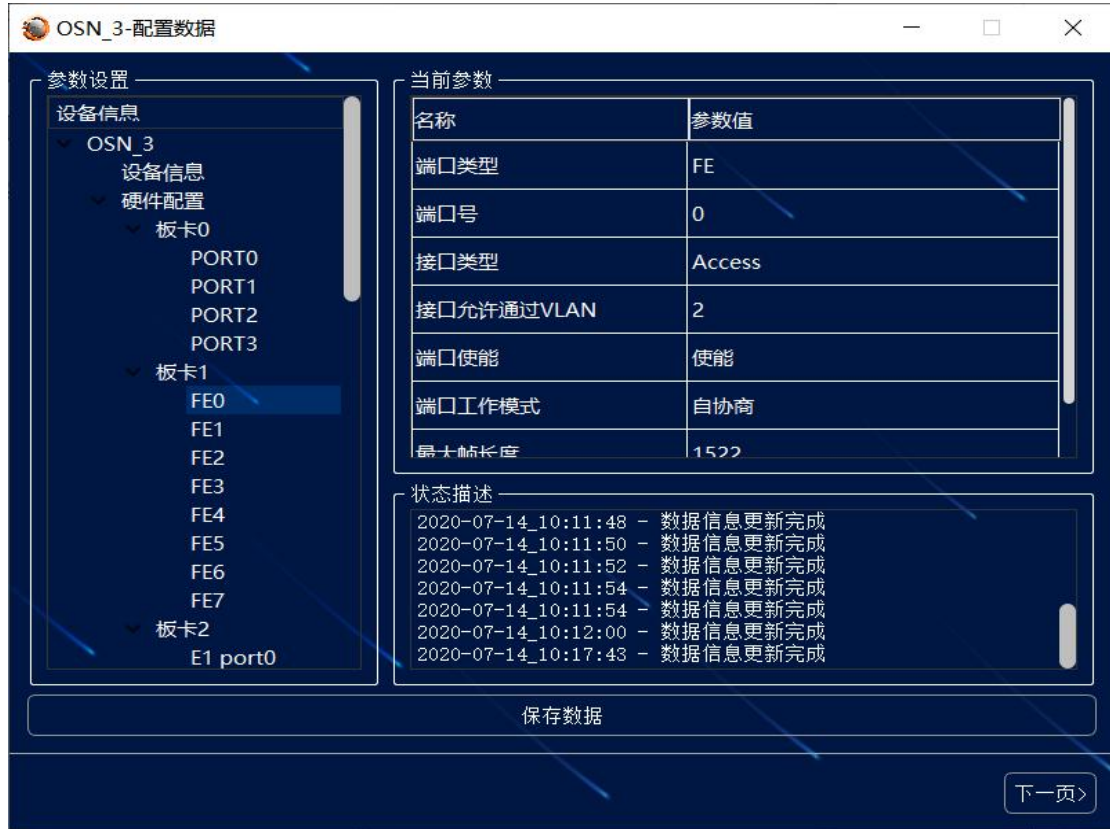
图 7.33-OSN 3 设备添加单板（板卡 2 的 FE0 端口允许通过的 VLAN 为 2）
