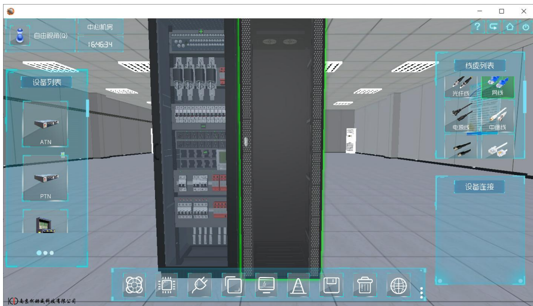
图 5.6 电源柜与机柜安装
