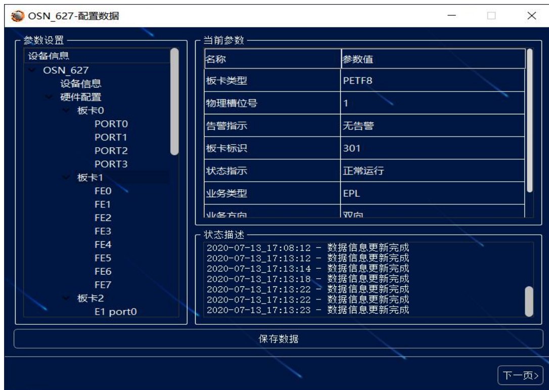
图 5.15 OSN 2 添加单板 (AUX、CL4、PETF8、SXCSA、SCC)
