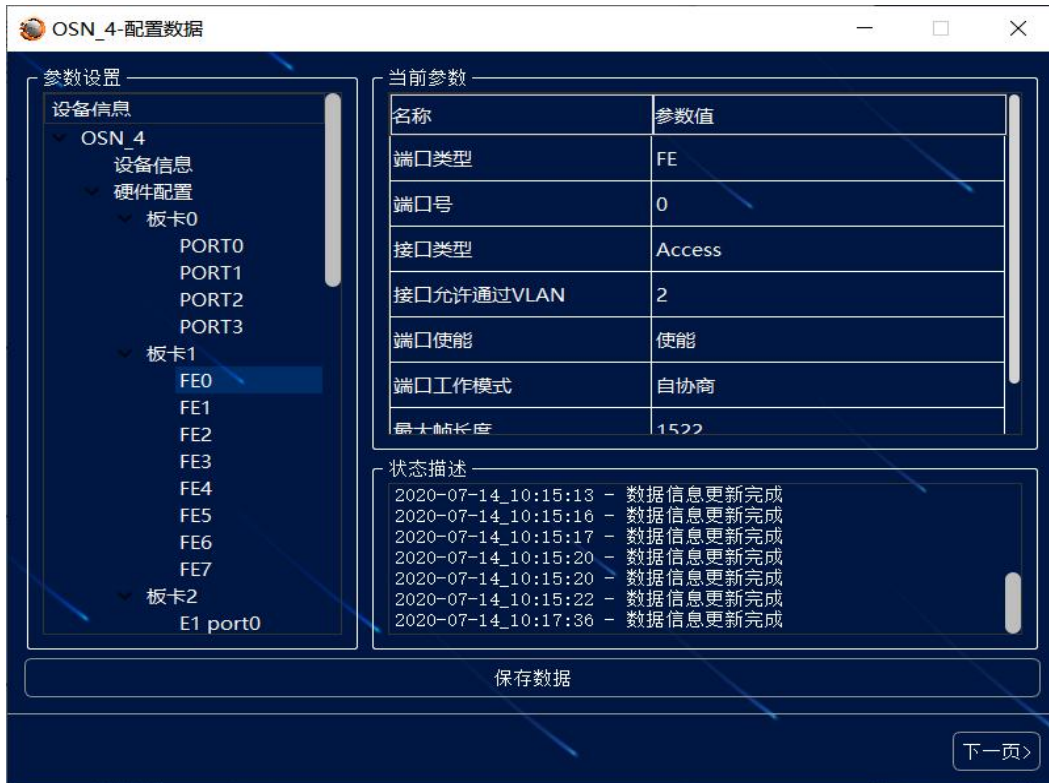
图 7.39-OSN4 设备添加单板（板卡 2 的 FE0 端口允许通过的 VLAN 为 2）
