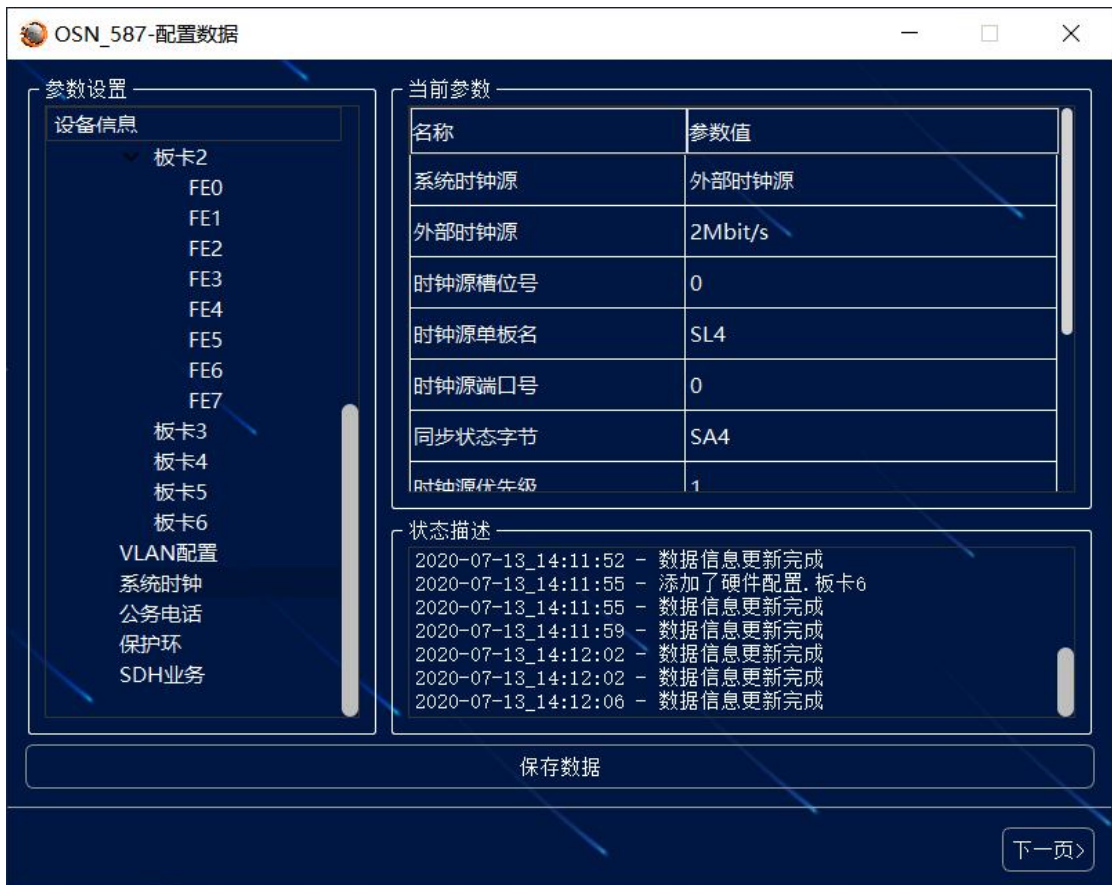
图 2.7 添加单板（AUX、SL4、PETF8、SXCSA、SCC），以及配置系统时钟
