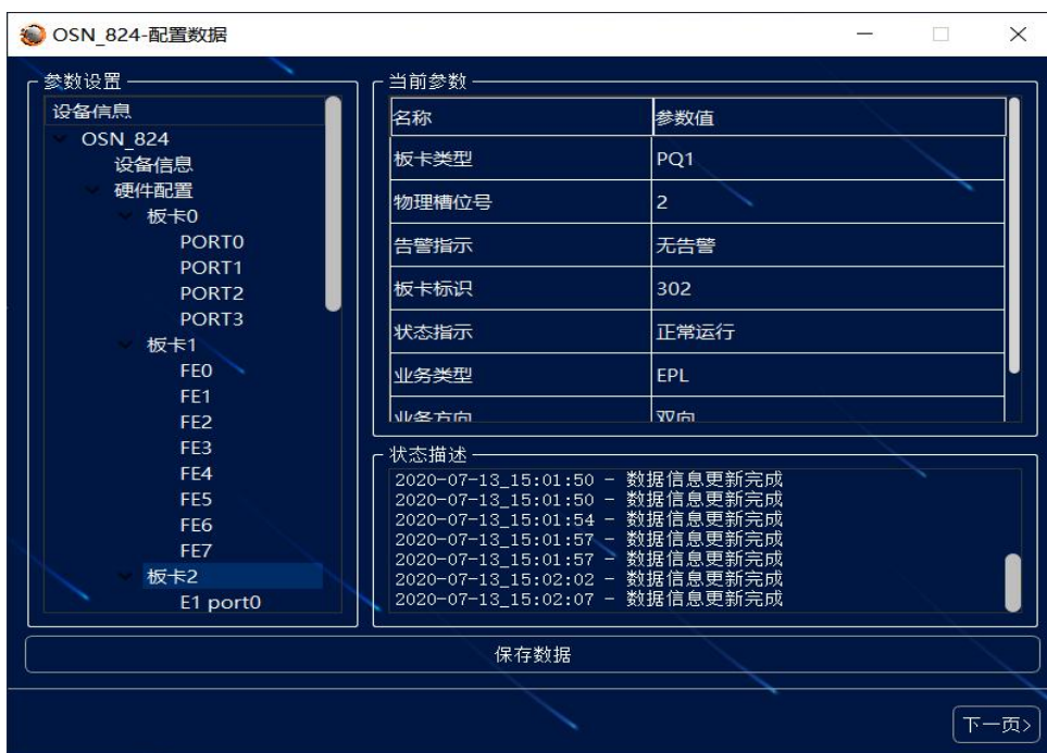
图 3.12-添加单板 (AUX、CL4、PQ1、SXCSA、SCC)
