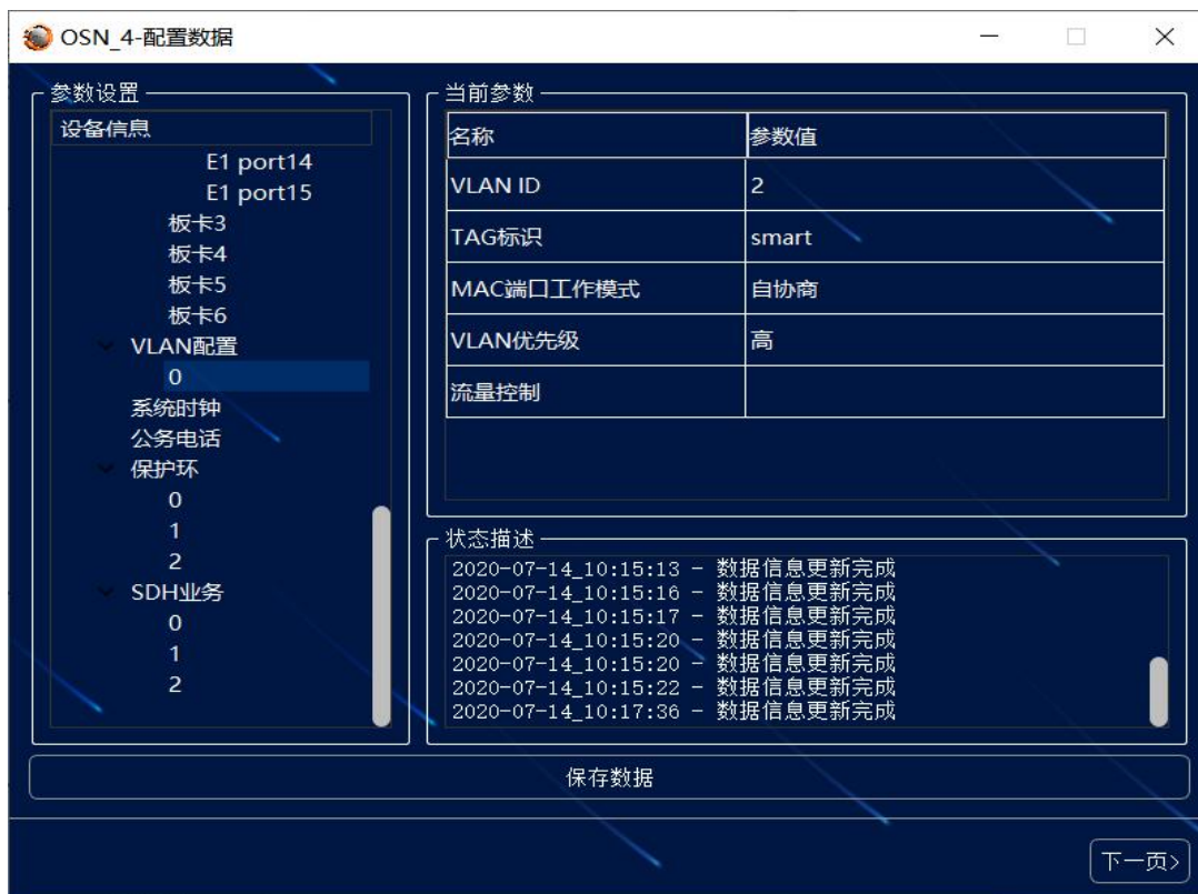
图 7.40-OSN 4 添加 VLAN 配置
