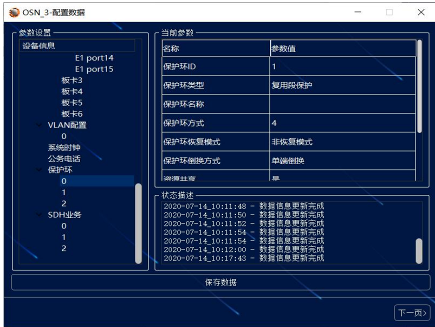
图 7.35-OSN 3 添加三个保护环（复用段保护、复用段保护、通道保护）
