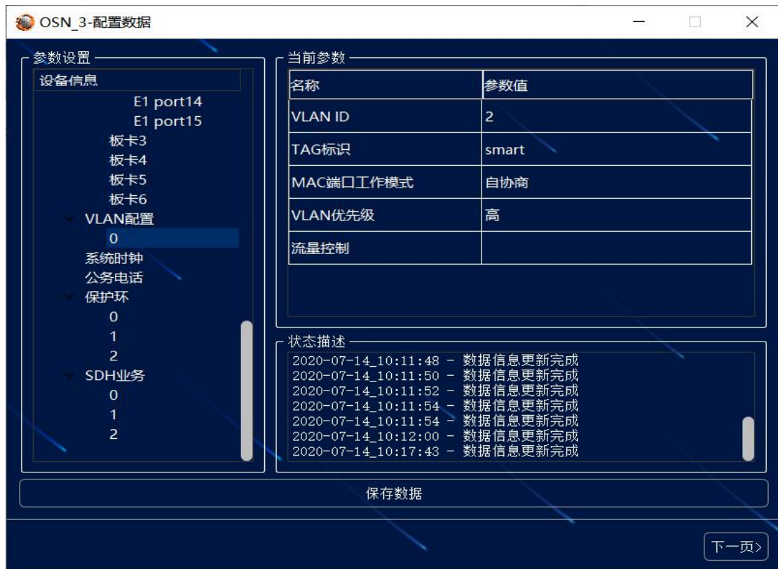
图 7.34-OSN 3 设备添加 VLAN 配置（VLAN ID 为 2）
