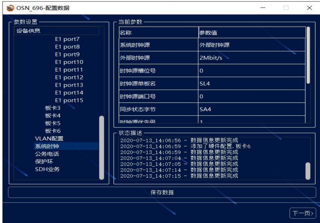
图 2.5 添加单板 (AUX、SL4、PETF8、SXCSA、SCC), 以及配置系统时钟
