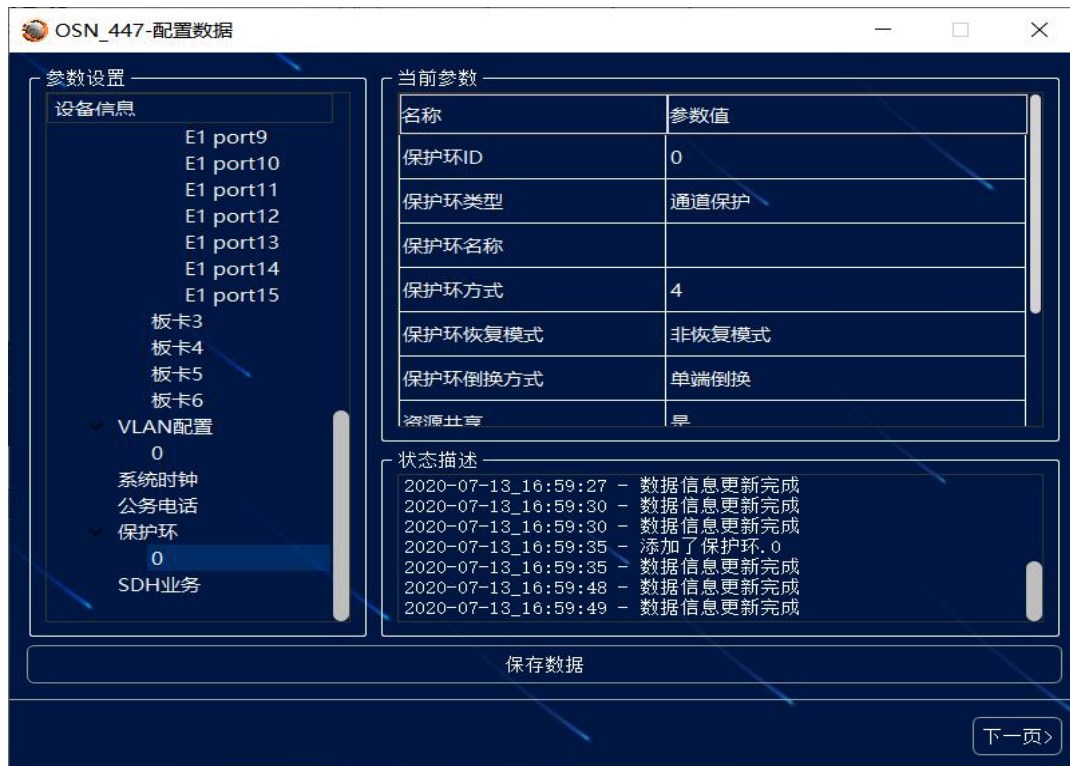
图 5.13 添加保护环（保护环类型改为通道保护）
