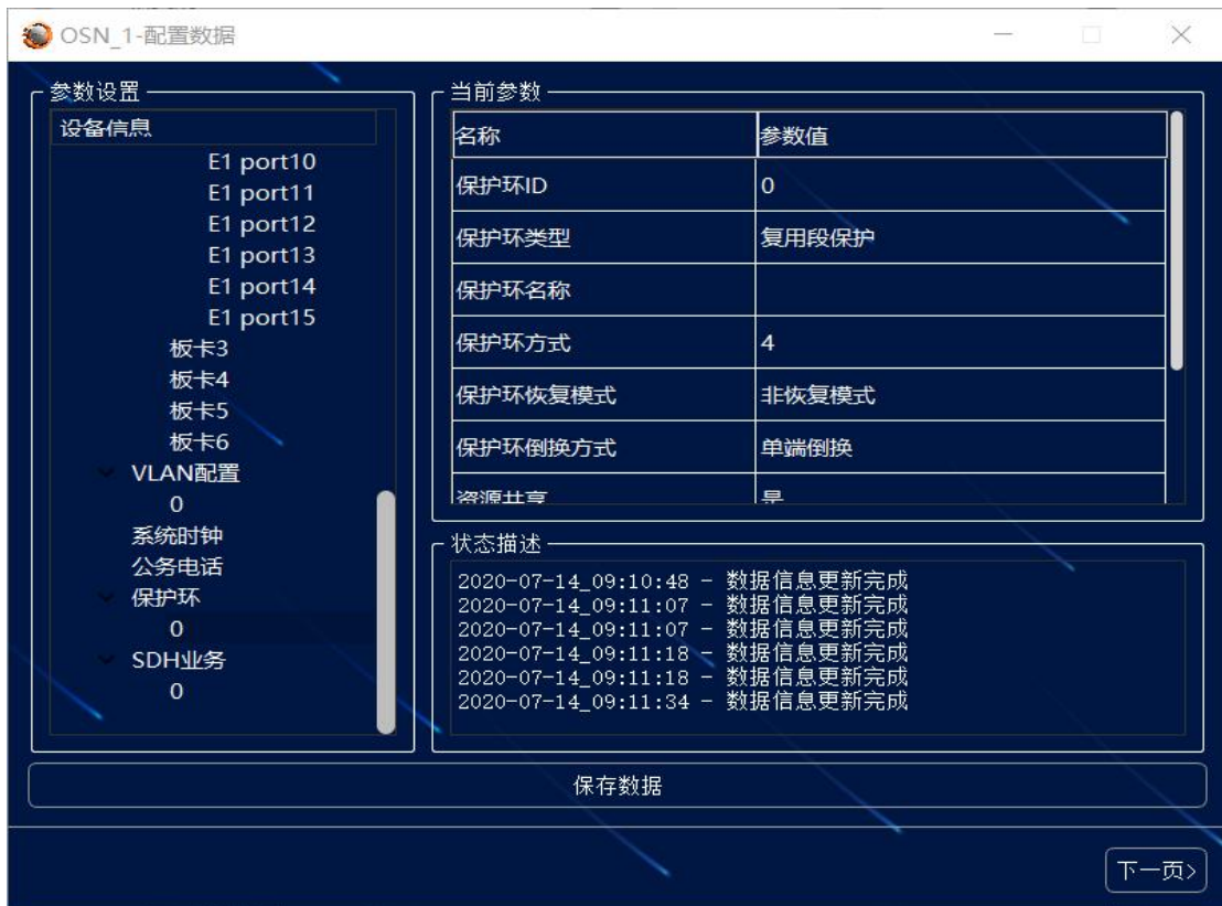
图 6.13 添加保护环（保护环类型改为复用段保护）
