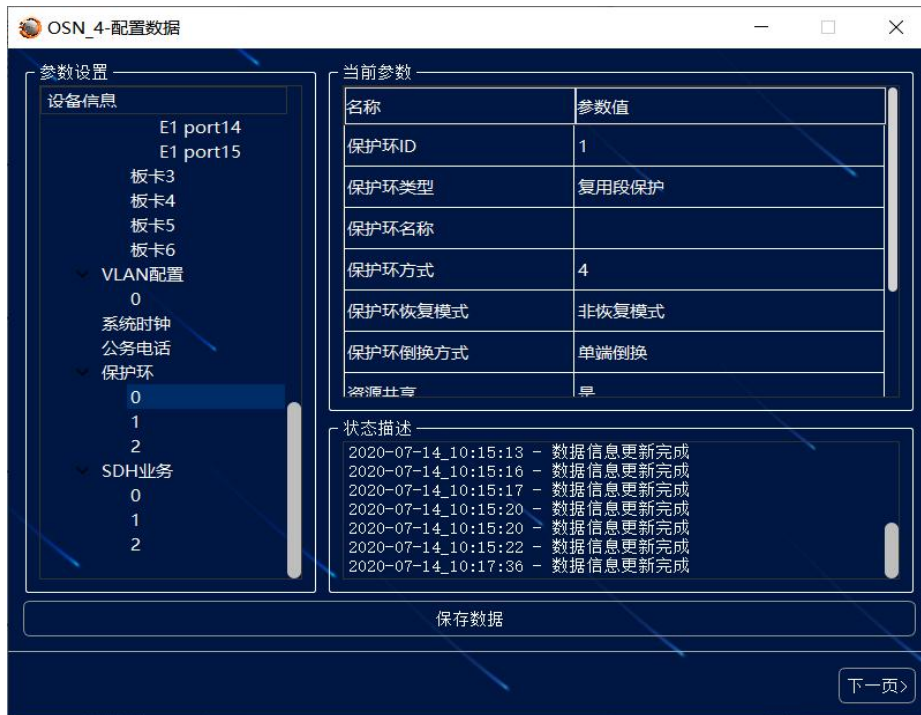
图 7.41-添加三个保护环（复用段保护、复用段保护、通道保护）
