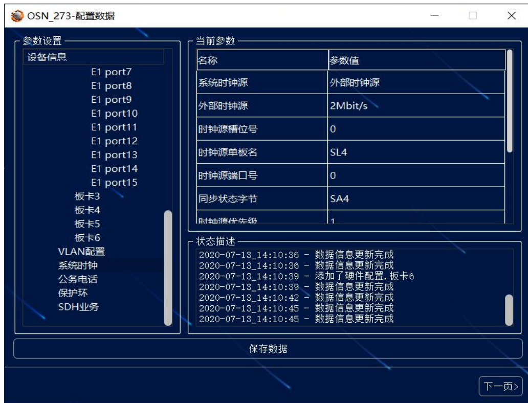
图 2.6 添加单板 (AUX、SL4、PETF8、SXCSA、), 以及配置系统时钟
