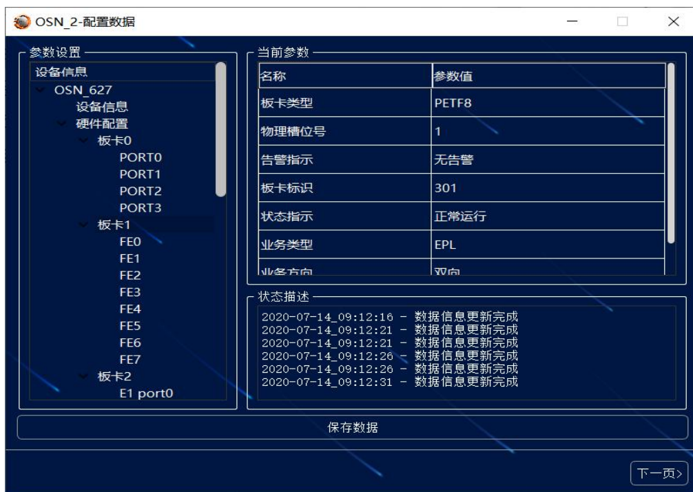
图 6.15 OSN 2 添加单板 (AUX、CL4、PETF8、SXCSA、SCC)
