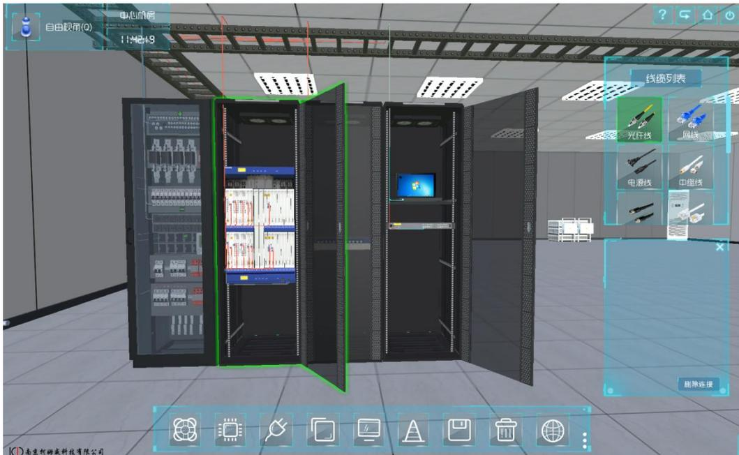
图 4.3 完成安装交换机与电脑示意图
