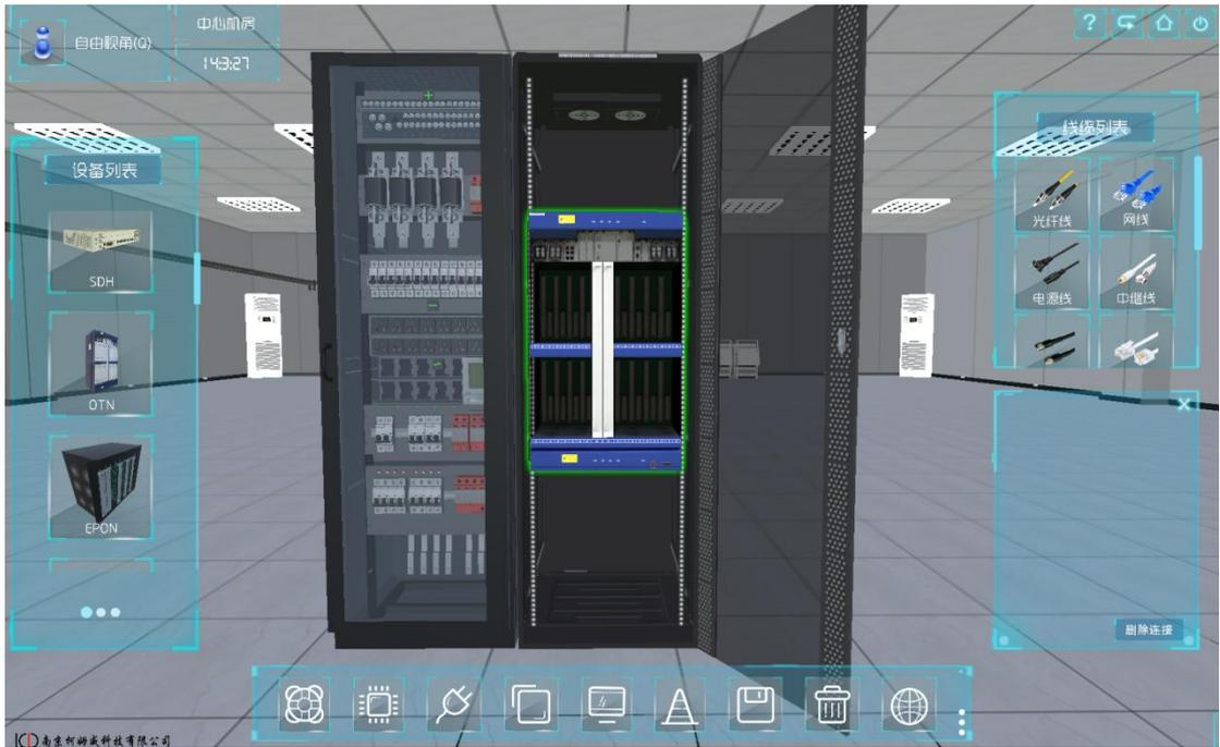
图 1.8 在机柜中安装 OTN 设备
