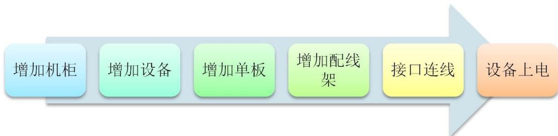
图 8 中心机房设备安装流程
