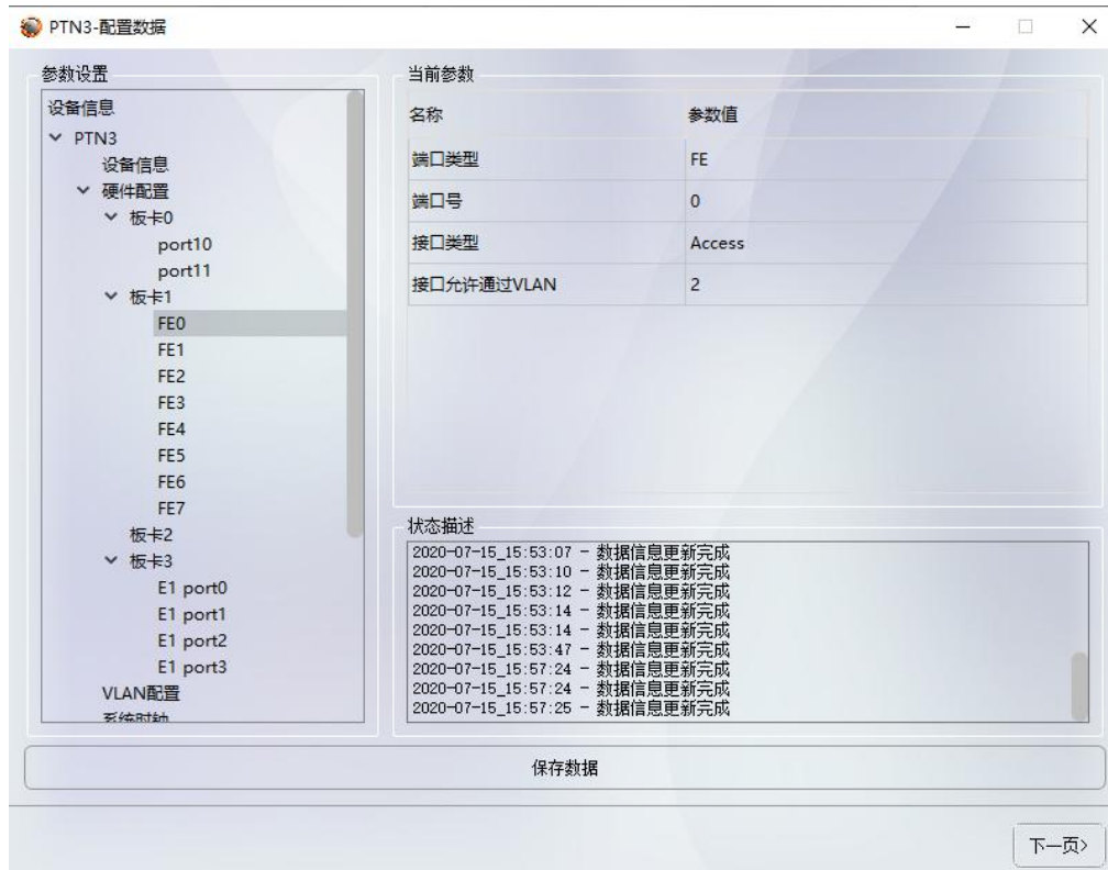
图 6.36-PTN3 设备的板卡 1 的 FE0 端口允许通过的 VLAN 为 2
