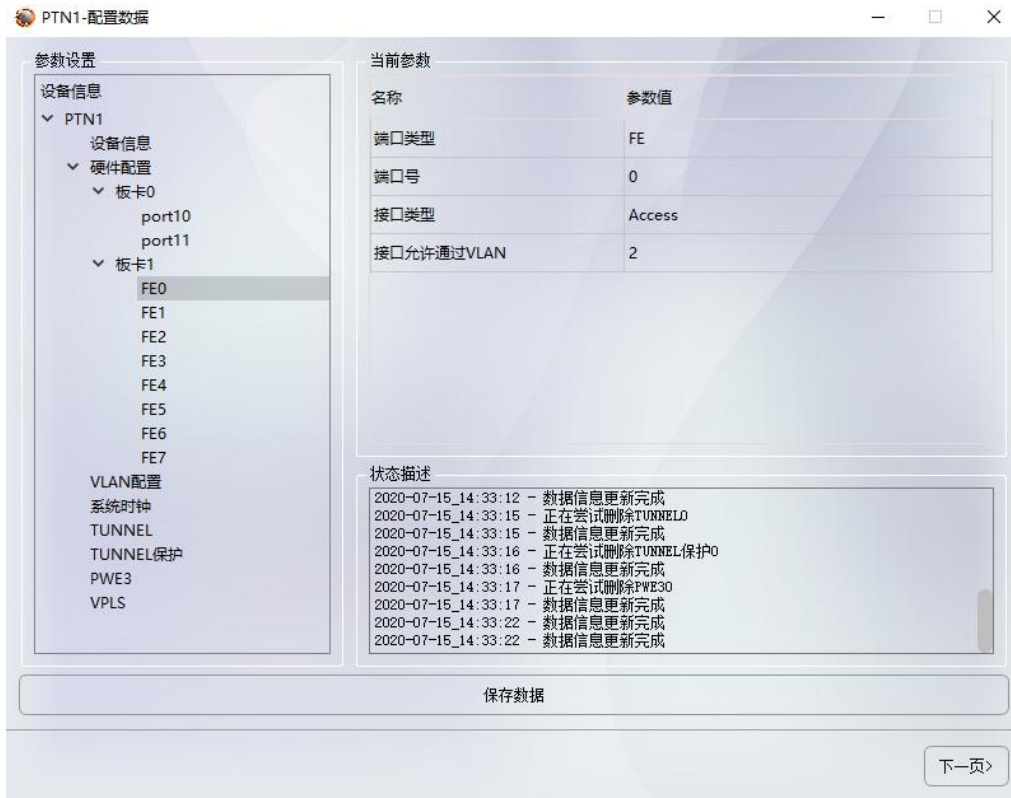
图 3.11-PTN1 添加单板并板卡 1 的 FE0 端口允许通过 VLAN 为 2
