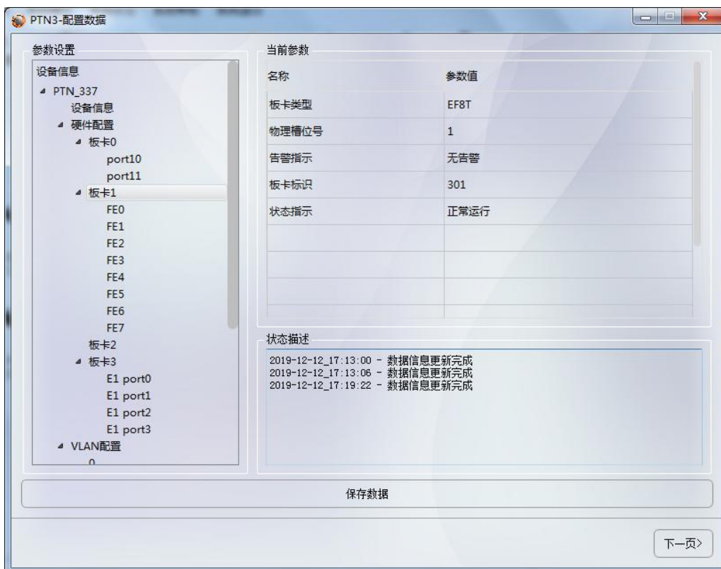
图 6.27-PTN3 设备添加单板（EG2、EF8T、CXP、ML1A）
