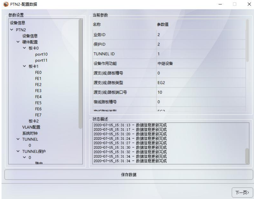
图 5.19-添加 VPLS 业务（设备类型为中继设备，ID2，具体参考数据规划表）
