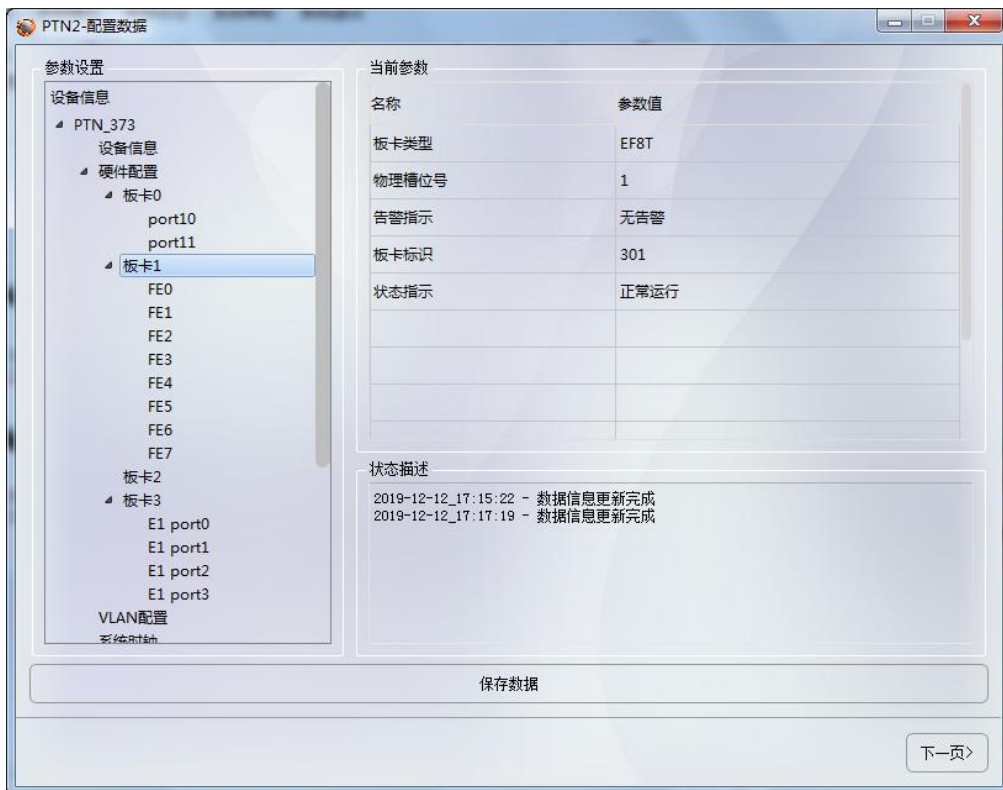
图 6.24-PTN2 设备添加单板（EG2、EF8T、CXP、ML1A）
