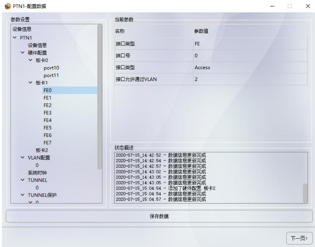
图 5.11-PTN1 添加单板 (EG2、EF8T、CXP) (在板卡 1 的 FE0 和 FE1 端口允许通过的 VLAN 为 2)
