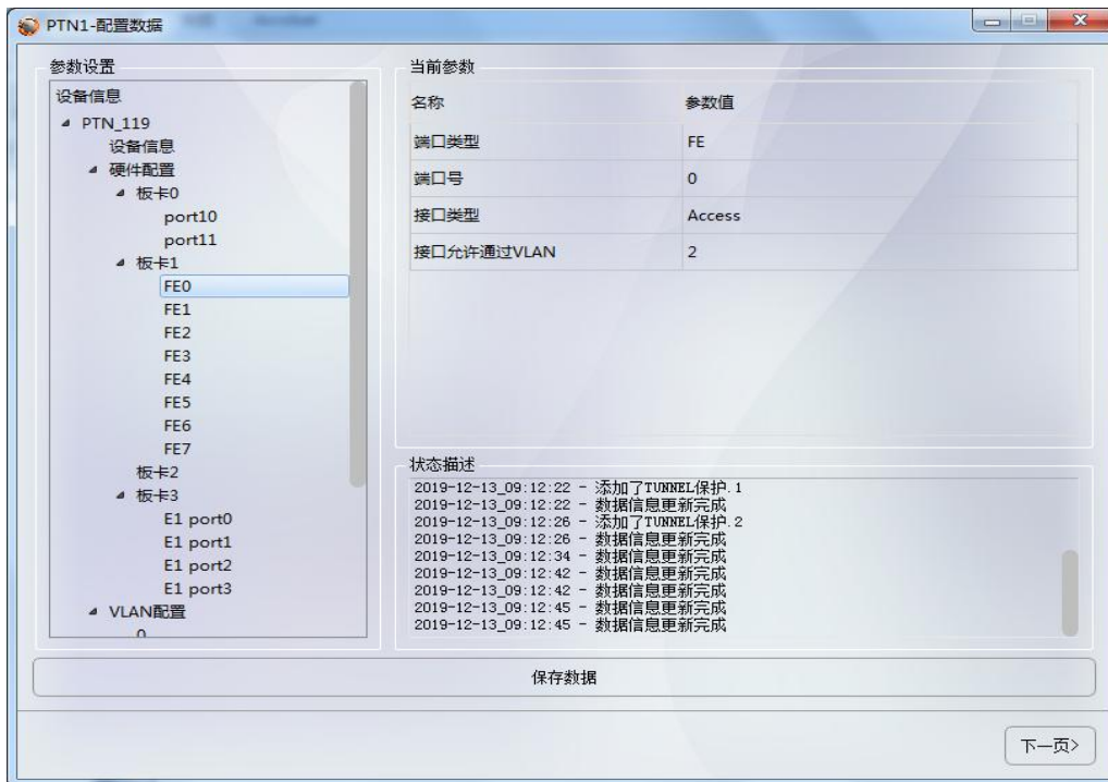
图 6.30-PTN1 设备的板卡 1 的 FE0 端口允许通过 VLAN 为 2
