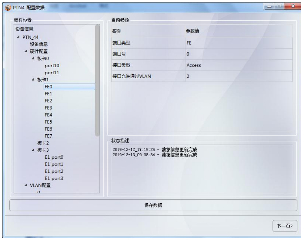
图 6.45-PTN4 设备的板卡 1FE0 端口允许通过的 VLAN 为 2
