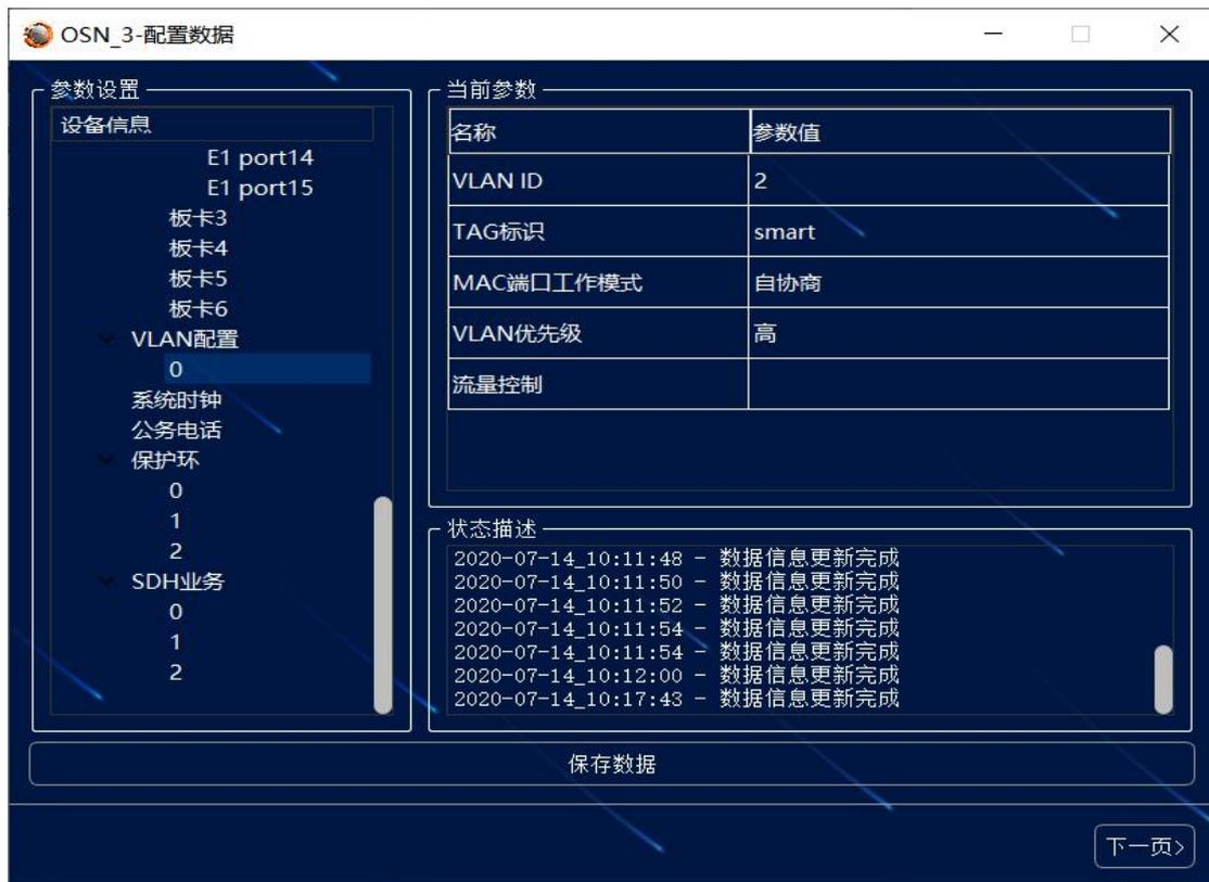
图 7.34-OSN 3 设备添加 VLAN 配置（VLAN ID 为 2）
